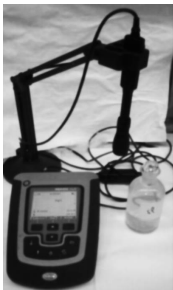
Obrázek 9 HQ430d stolní multimetr 1-vstupový se stojanem pro 3 sondy se sondou rozp. kyslíku (LDO)
