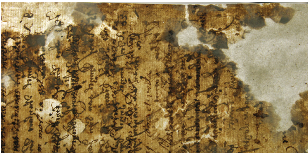
Obr. č. 74 Ukázka opravy poškozené papírové podložky doléváním v kombinaci se sítěnkou
