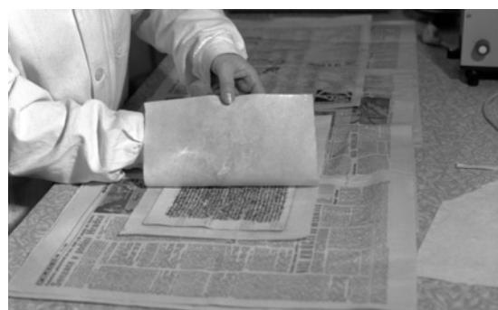
Obr. č. 87, 88 Nanesení želatinového roztoku (ve vodní lázni zahřátá směs potravinářské želatiny, vody a glycerinu) plochým štětcem na hladký filtrační papír, jež plnil funkci nosného materiálu.
