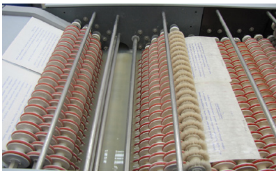
Obr. č. 60, 61 Ukázka metody hromadné neutralizace zařízením firmy „Neschen“
