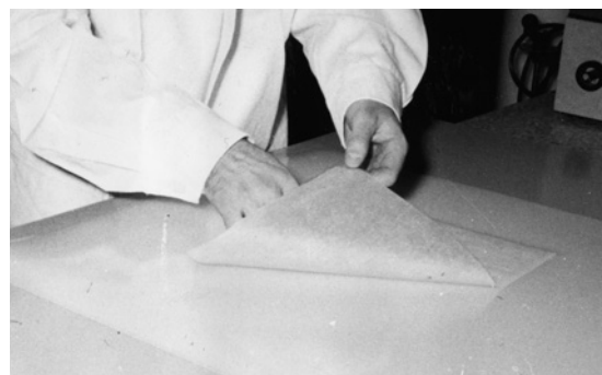
Obr. č. 78, 79 Příprava laminační fólie, na tenkou plastovou desku byla nanášena tenká vrstva předem upraveného laminačního lepidla, na kterou byl kolébkovitým pohybem položen japonský papír tak, aby nedošlo k vytvoření vzduchových bublinek. Po zaschnutí, obvykle druhý den, se laminační fólie odřízla a sloupala z plastové desky.
