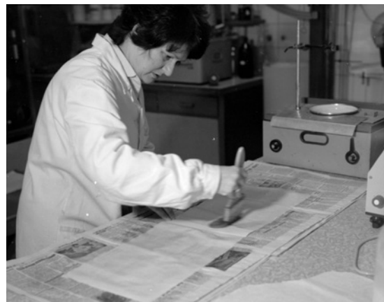
Obr. č. 87, 88 Nanesení želatinového roztoku (ve vodní lázni zahřátá směs potravinářské želatiny, vody a glycerinu) plochým štětcem na hladký filtrační papír, jež plnil funkci nosného materiálu.
