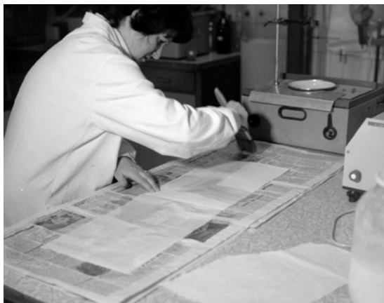
Obr. č. 87, 88 Nanesení želatinového roztoku (ve vodní lázni zahřátá směs potravinářské želatiny, vody a glycerinu) plochým štětcem na hladký filtrační papír, jež plnil funkci nosného materiálu.
