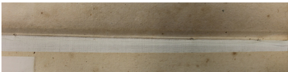
Obr. č. 98 Ukázka obtočené předsádky plátěným proužkem
