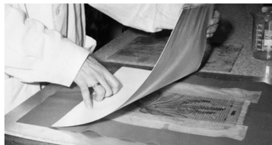
Obr. č. 82, 83 Přesahující části položených záplat nepřišly do styku s laminační fólií, kdy lepidlo bylo aktivováno etanolem, poté byl celý sendvič překryt měkkou savou podložkou a zalisován
