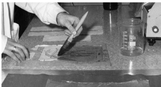
Obr. č. 80, 81 Navlhčený zteřelý dokument 80% roztokem etanolu byl položen na laminační fólii (na její leskolou stranu), poté byly navlhčeny a přiloženy záplaty z japonského papíru, které byly větší než chybějící část, tedy přesahovaly na originál.
