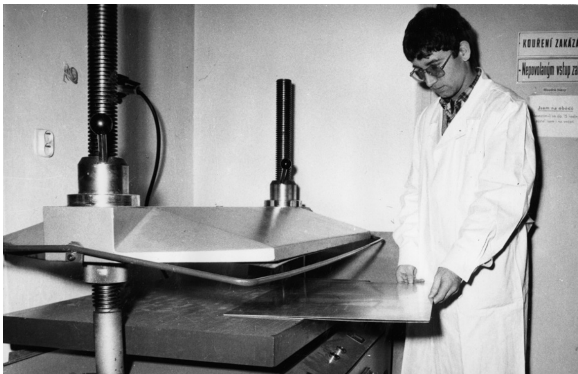
Obr. č. 84 Lisoání mezi zinkovými plechy v hydraulickém lise
