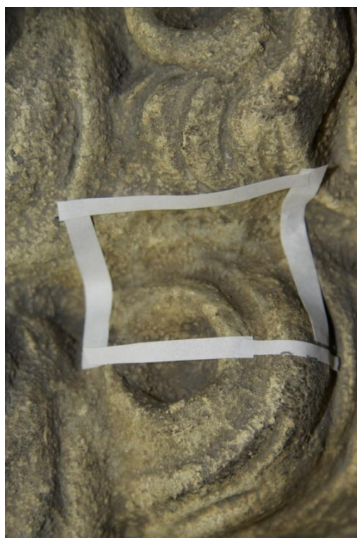
Obr. 109 Detail zkoušky laserového dočištění povrchu, stav po. Patrná změna barevnosti.
