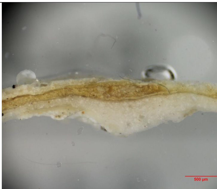
Obr. 8: Mikrofotografie nábrusu ve viditelném světle
