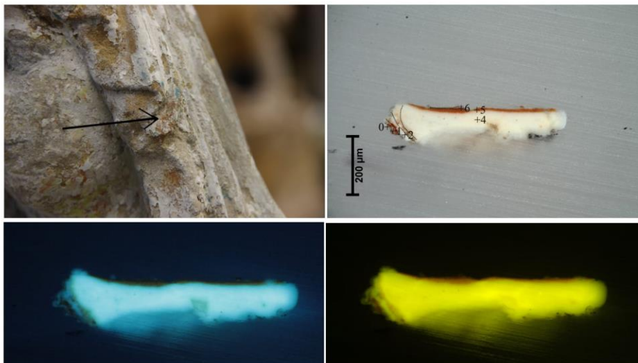
Obr. 15 a-d: Stratigrafie povrchových úprav vzorku ST7 (9266). Popis: a) Detail místa odběru vzorku. b) Snímek nábrusu v odraženém světle z optického mikroskopu Nikon LV100 při zvětšení na mikroskopu 200x, c, d) snímky v UV a modrém světle.
