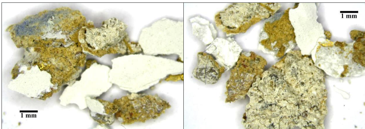
Obr. 55, 56 Stereomikroskopie – dokumentace vzorku ze svrchní a spodní strany.
