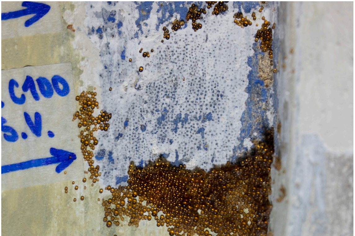
Obr.33: Detail zkoušky čištění: účinek iontoměniče Purolite ® C100 H. Patrný čistící efekt v místě kontaktu iontoměničových kuliček s podkladem.
