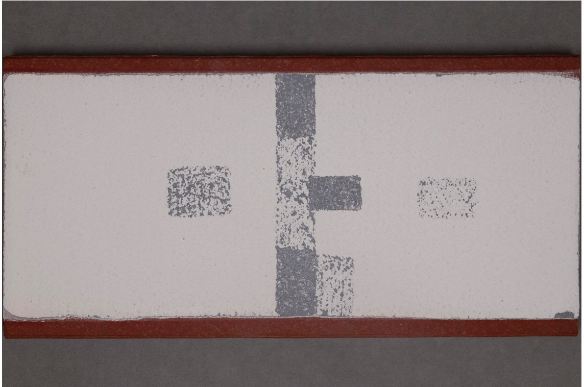
Obr. 95: Dlaždice č. 12: srovnávací zkouška mechanického odkryvu čepelkovým skalpelem.
