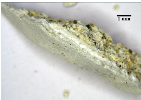
Obr. 43, 44 Stereomikroskopie – dokumentace vzorku z boční a svrchní strany.
