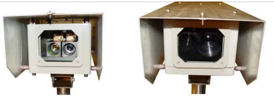
Obrázek 28 - Experimentální optický bezdrátový spoj ATMO TL - 02_DUAL – vlevo vysílač, vpravo přijímač. (Kvíčala, 2009)
