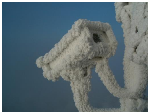
Obrázek 47 - Námraza na krytu přijímače na Milešově
