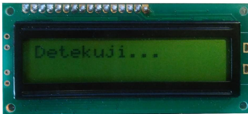
Obrázek 7 - 16x2 LCD displej
