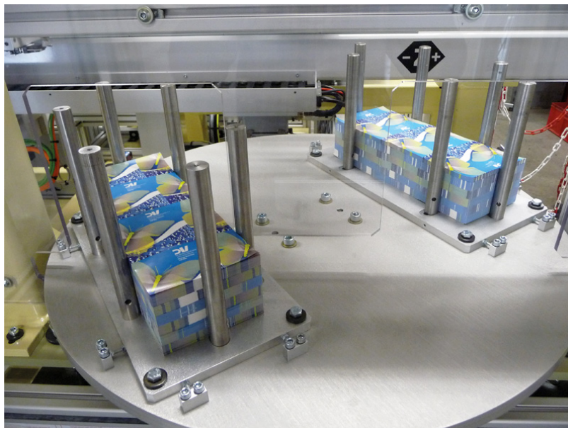
Obrázek 24. Držák in-mould etiket.
