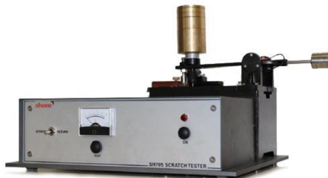
Obr.č. 6 Přístroj Motorised Scratch Tester Sheen 705
