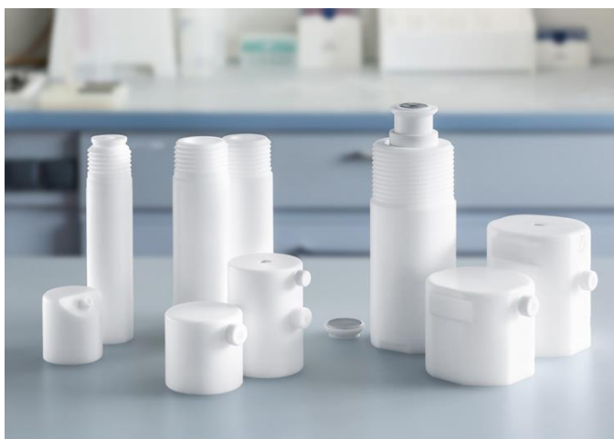
Obrázek 8 Rozkladné nádoby z PTFE [37]
