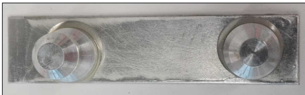
Obrázek 26. Hliníkový adherend připravený k odtrhovým zkouškám.
