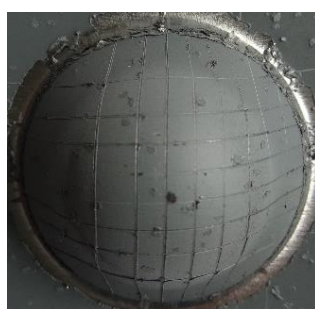
Srovnávací nátěr plněný pouze Zn při OKP = 67 %
