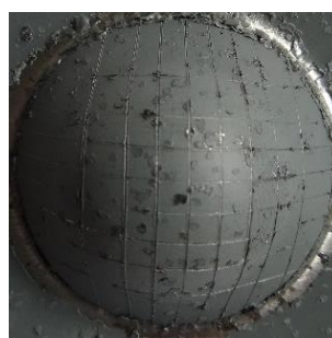
Srovnávací nátěr plněný pouze Zn při OKP = 67 %
