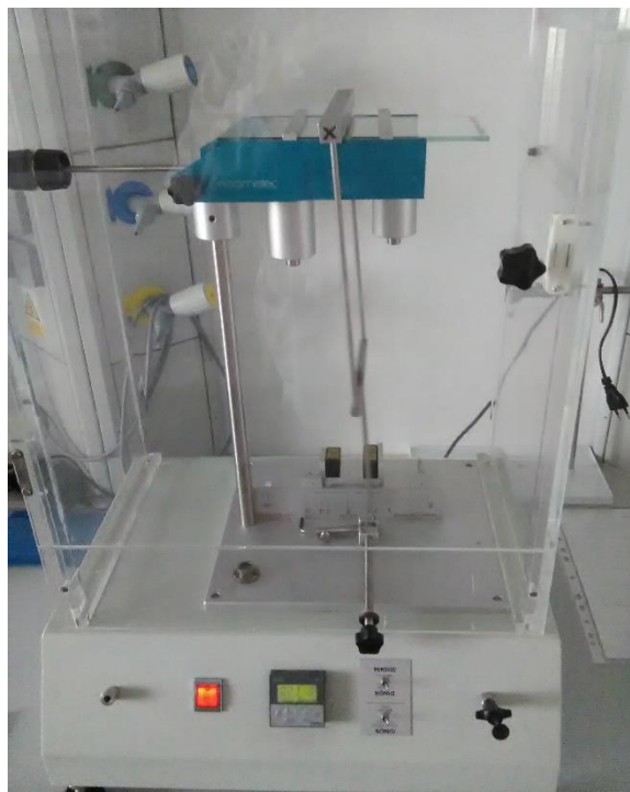
Obrázek 10: Používaný kyvadlový přístroj AUTOMATIC 500
