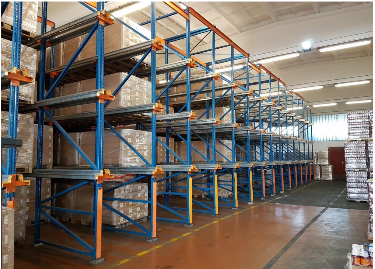
Obrázek 11 Pevný paletový regálový systém (autor)
