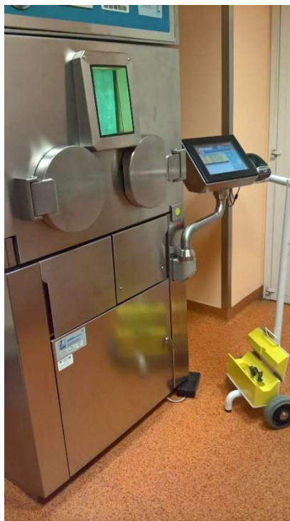
Obrázek 7 - Digestoř pro přípravu radiofarmak a stínící box
