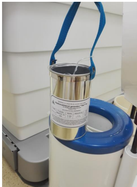
Obrázek 7 – Hermetická plechovka s generátorem (autor)
