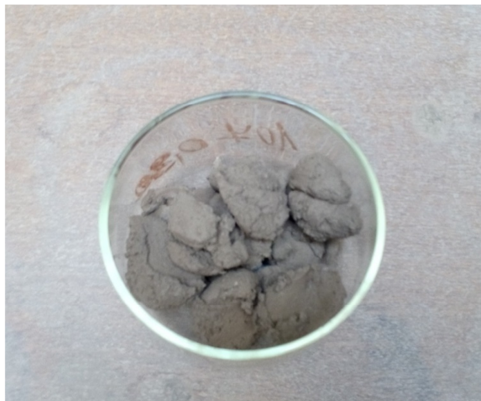
Obrázek 2 - Vysušená zemina pro určení přirozené vlhkosti [1]
