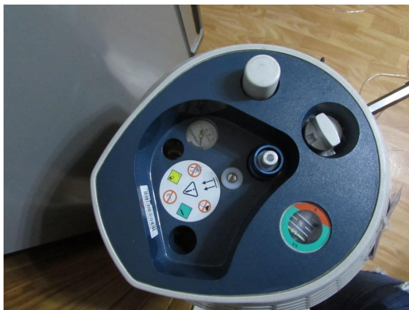
Obrázek 44 Otvor k plnění malé přenosné lahve
