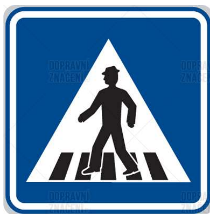
Obrázek 9 Informativní provozní dopravní značka IP06 – Přechod pro chodce
