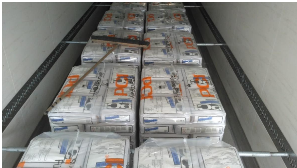
Obr. 16 Zabezpečení nákladu pomocí rozpěrných tyčí
