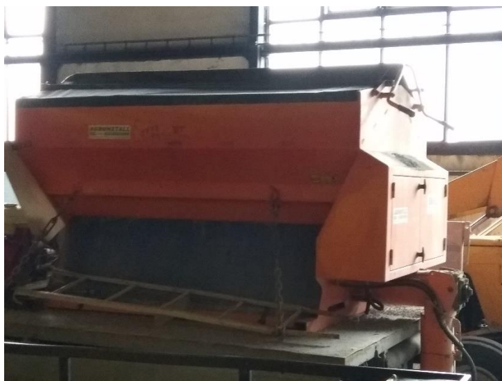
Obrázek 12 Motorová sypačová nástavba
