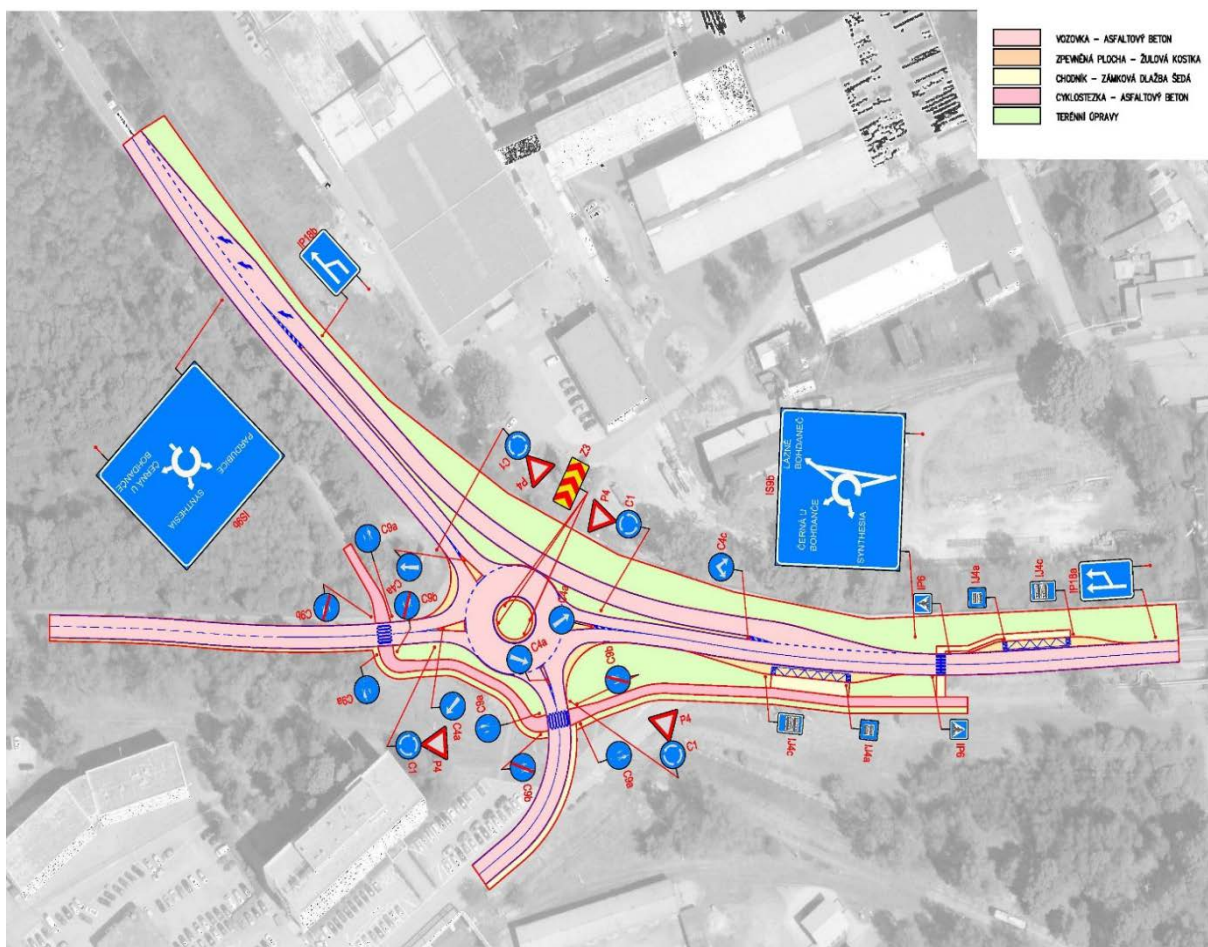
Obr.38 Návrh svislého a vodorovného dopravní značení na okružní křižovatce
