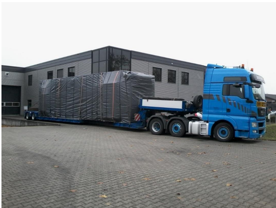
Obrázek 9 Ochranná plachta u nadrozměrného nákladu
