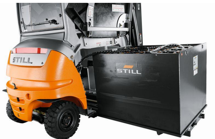
Obrázek 26 RX 60-25 Výměna baterie
