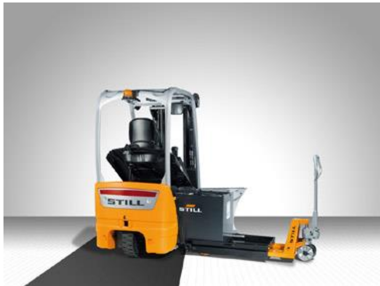
Obrázek 28 RX 50-13 Výměna baterie
