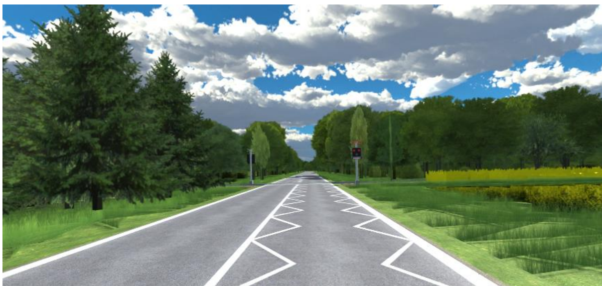
Obr. 21 Návrh vodorovného dopravního značení
