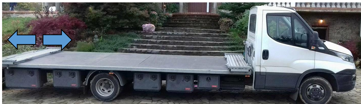
Obr.5 Posuvnost druhé pojezdové kolejnice
