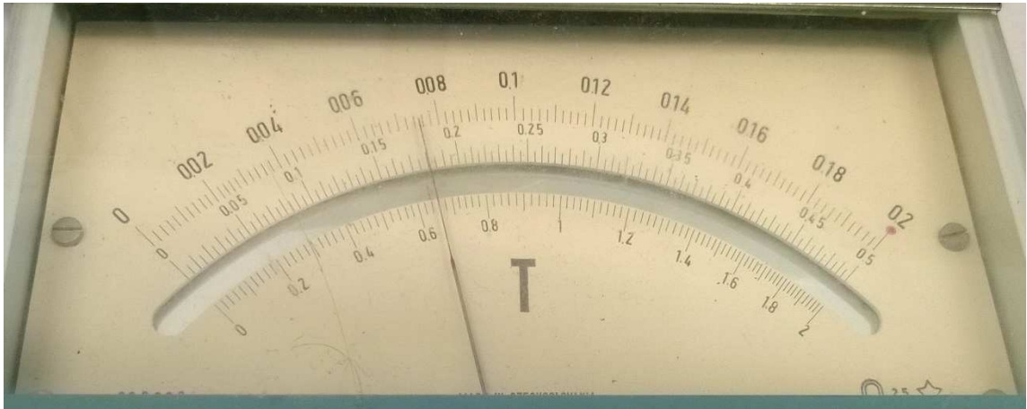
Obr. 7.3.1: Naměřená remanence rotoru po zmagnetování
