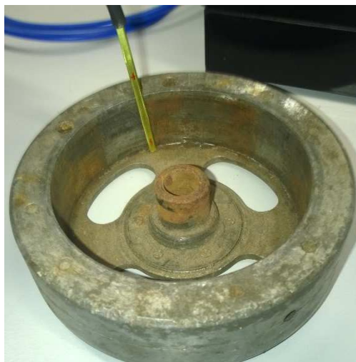
Obr. 7.1.1: Měření remanence rotoru sondou
