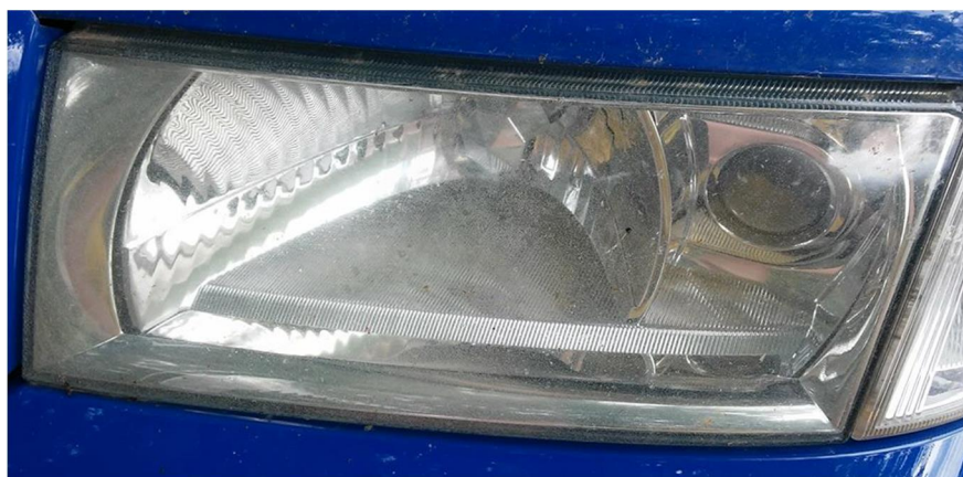
Obrázek 13. Mírné po-kození krycího skla sv tlometu na pouflitém vozidle
