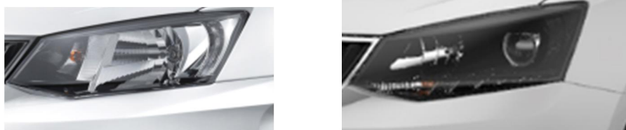
Obrázek 6. Parabolický a projektorový halogenový sv tlomet na vozech Fabia [12]
