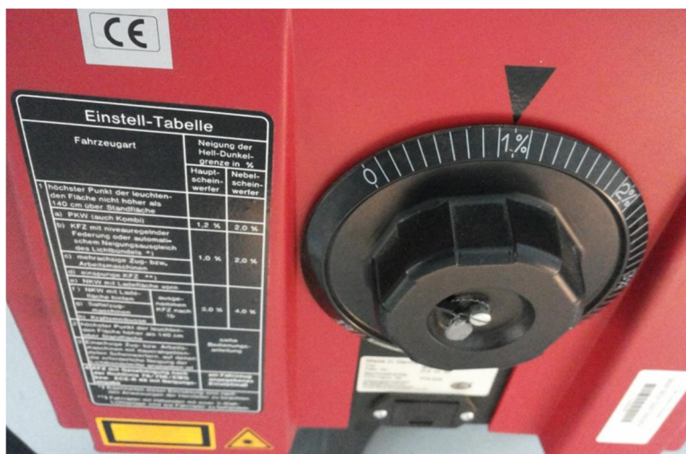
Obrázek 11. Kontrola se ízení sv tlomet na regloskopu
