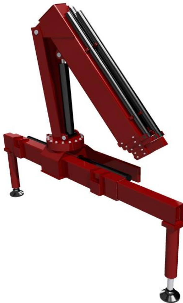
Obrázek 19: Vysunutí pomocné vzpěry
