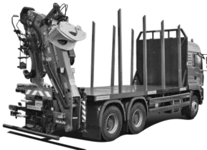
Obrázek 5: Provedení s montáží jeřábu vzadu na nákladním automobilu MAN [19]
