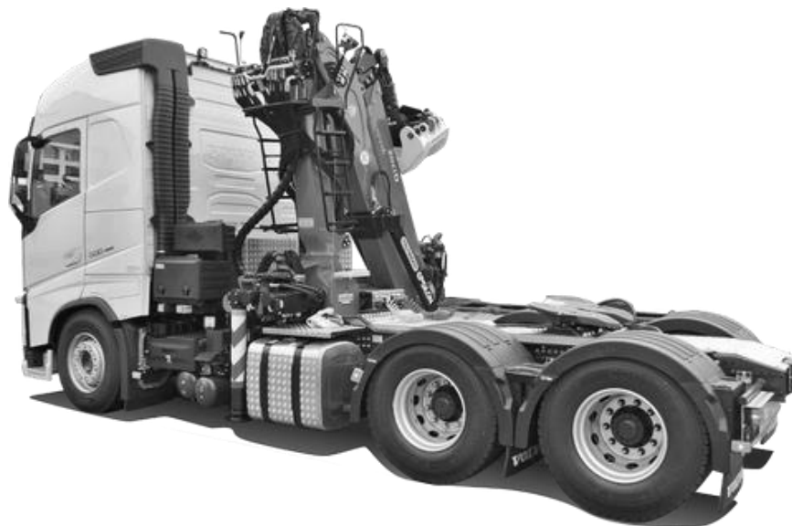
Obrázek 4: Provedení montáže za kabinou na nákladním vozidle Volvo [19]
