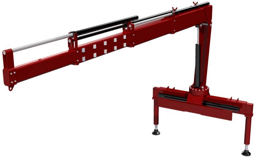
Obrázek 16: Model sestavy nakládacího jeřábu
