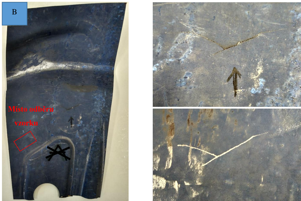
Obr. 27 – Výlisek oceli 22MnB5 s trhlinou
