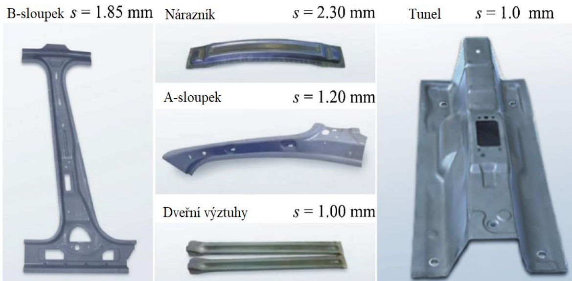
Obr. 11 - příklady dílů vyrobených z oceli 22MnB5 [5]
