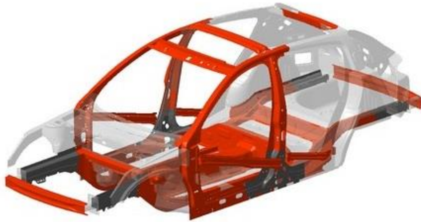
Obr. 12 - Oblast využití oceli 22MnB5 v moderním osobním automobilu [7]
