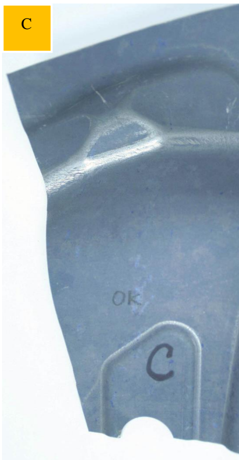
Obr. 28 – Výlisek oceli 22MnB5 bez defektu
