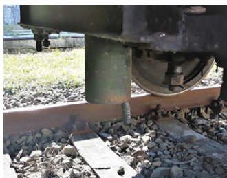
Obr. 6 Odpadní roura u vozu Ce 3-3413 typu gravitačního WC
