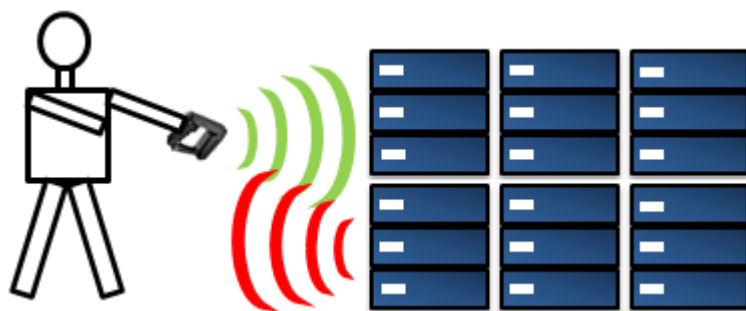
Obrázek 23 Princip načítání pasivních tagů na obalech ruční čtečkou (autor)
