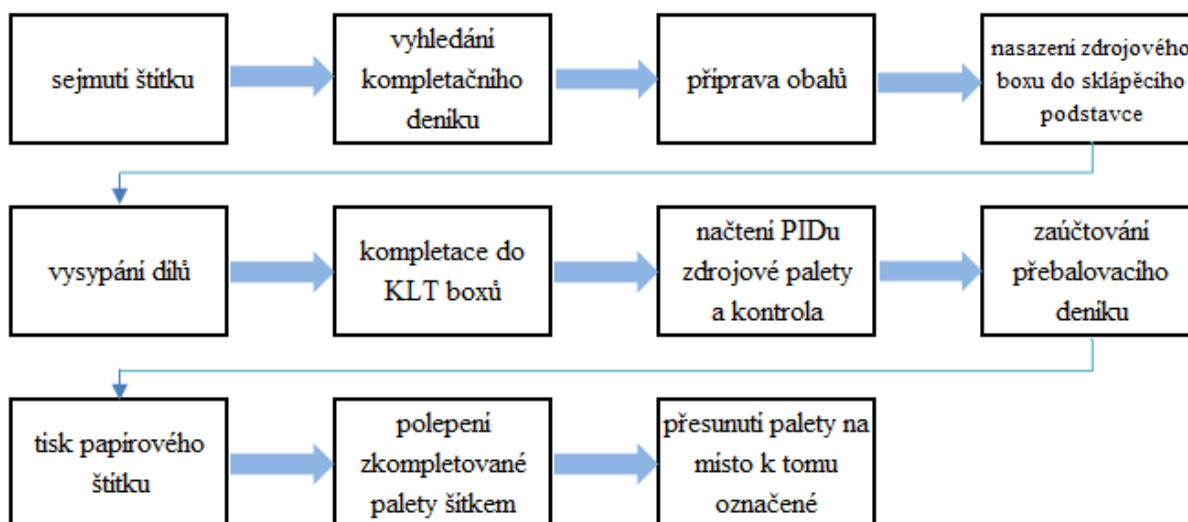
Obrázek 18 Návrh upraveného pracovního postupu kompletace vybraného zboží pomocí poloautomatizace (autor)
