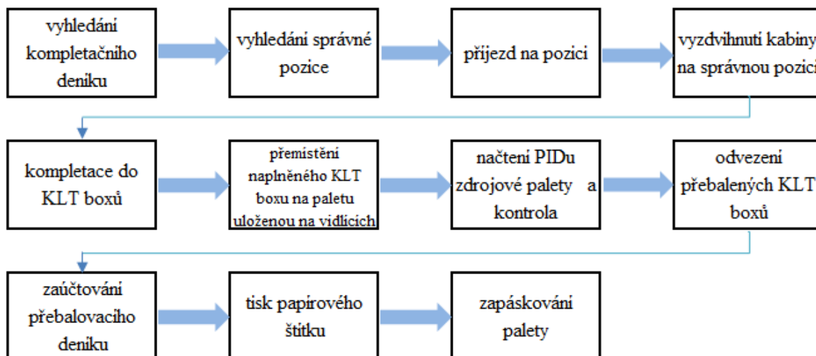
Obrázek 27 Popis navrhovaného pracovního postupu kompletace vybraného zboží pomocí kompletace v uličkách (autor)
