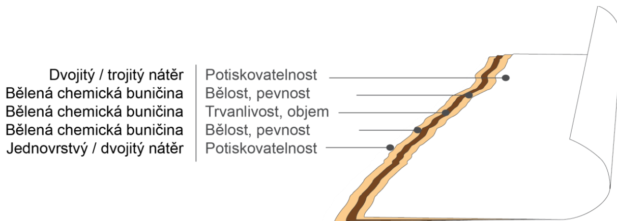
Obrázek 1 Struktura lepenky z bělené chemické buničiny (SBB) [7]
