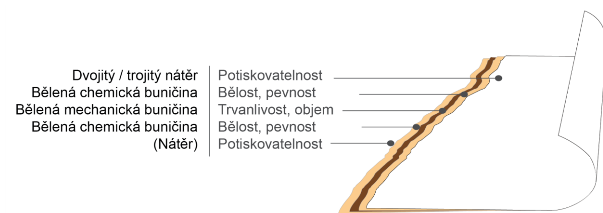
Obrázek 3 Struktura lepenky chromonáhrađa FBB [7]
