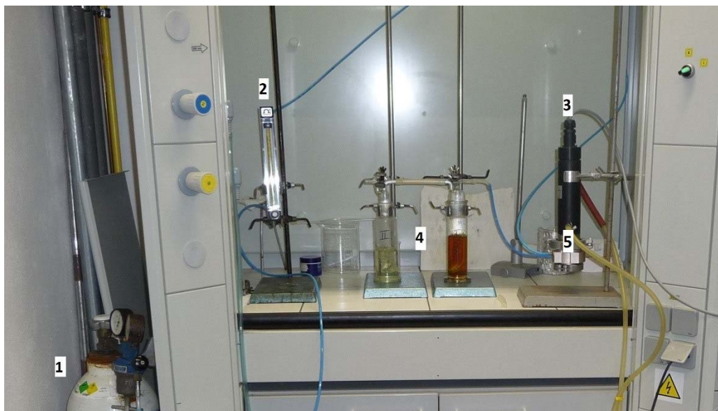
Obr. 26. Experimentální uspořádání aktinometrie: kyslíková bomba (1), průtokoměr (2), VUV lampa (3), promývačky s roztokem jodu (4) a reaktor (5).
