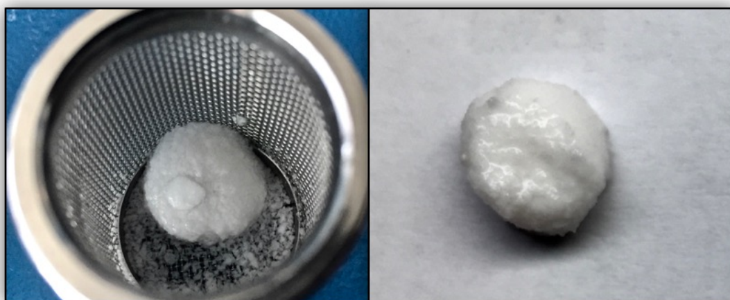
Obrázek 14: Směsná matricová tableta (F5) po disoluční zkoušce
