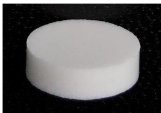
Obrázek 14: Tableta před disolucí připravená přímým lisováním
