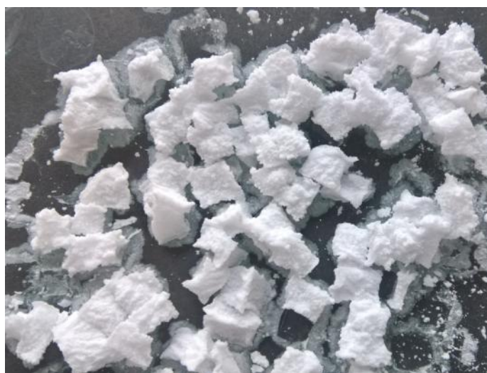
Obrázek 42: Snímky hydrogelu po nabobtnání v roztoku močoviny o koncentraci 4 mol.l -1
