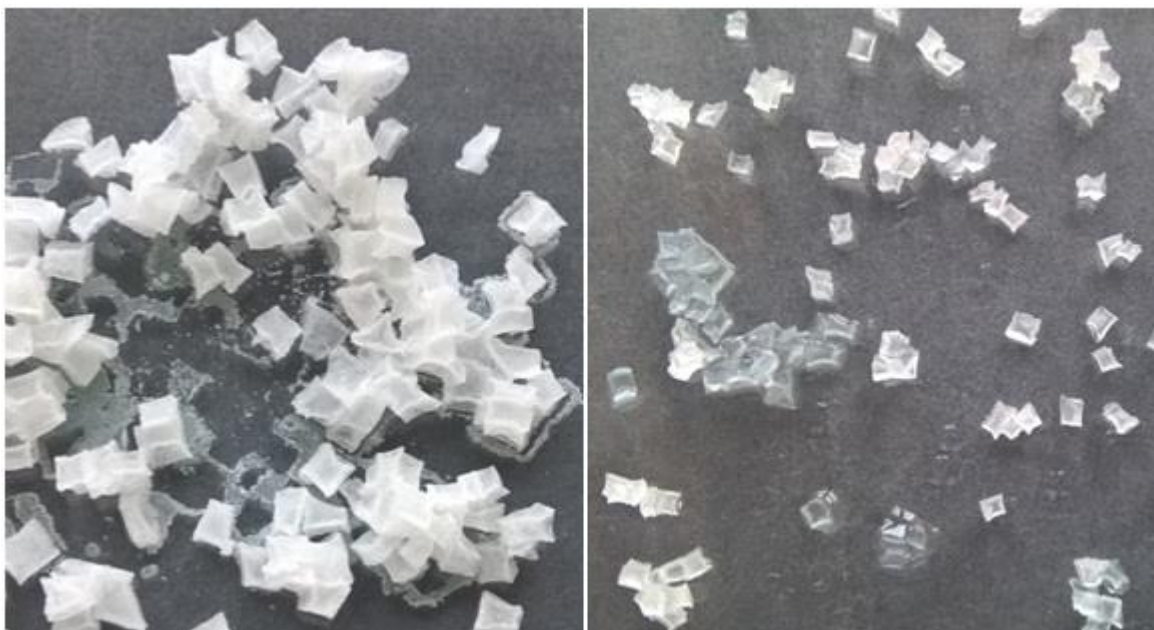
Obrázek 41: Snímky hydrogelu po nabobtnání ve 4 mol.l -1 (NH 4 ) 2 SO 4 (vlevo) a 4 mol.l -1 Ca(NO 3 ) 2 (vpravo)
