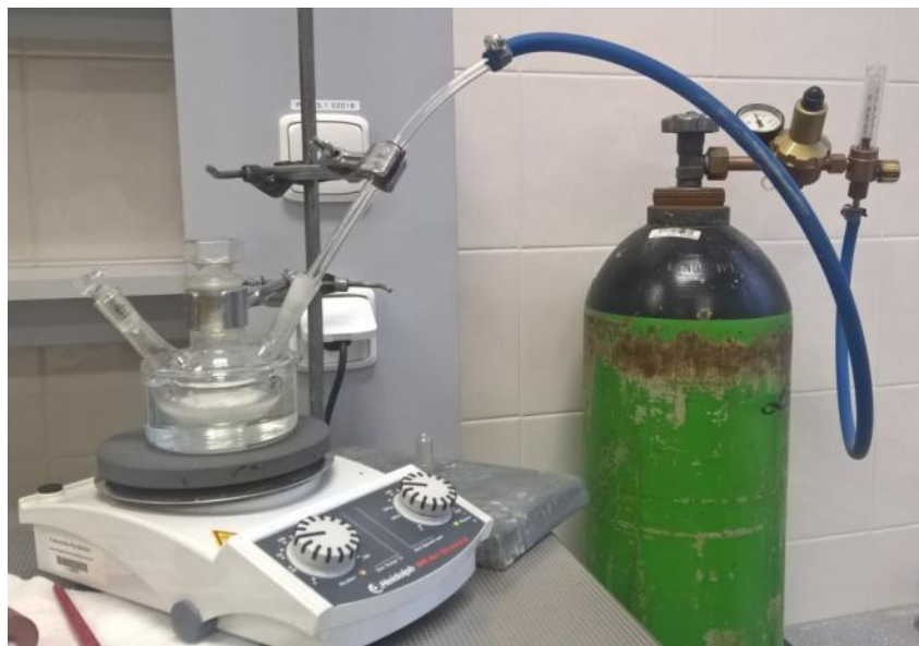
Obrázek 23: Aparatura pro přípravu hydrogelu pod inertní atmosférou
