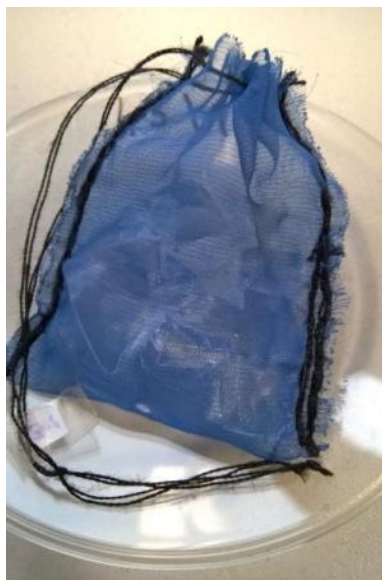
Obrázek 25: Monofilní sáček s nabobtnalým hydrogelem (metoda T-bag)
