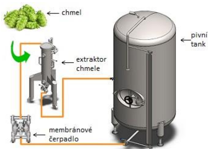
Obrázek 4: Technologické uspořádání při využití speciálního extraktoru chmele [25]
