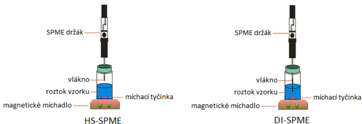
Obrázek 23: Uspořádání mikroextrakce tuhou fází [51, 77]
