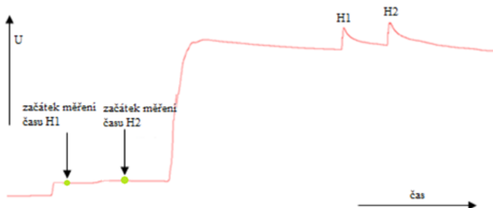
Obrázek 35: Odběr konvertovaného hydroxyprolinu (3,8 mM roztok). Elektrolytový systém I (pH 2,4)
