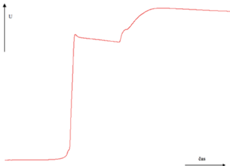
Obrázek 38: Izotachoforetický záznam kyseliny asparagové (0,001 M roztok) bez konverze. Elektrolytový systém II (pH 3,6)
