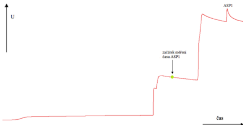
Obrázek 43: Odběr konvertované kyseliny asparagové (3,76 mM roztok). Elektrolytový systém II (pH 3,6)
