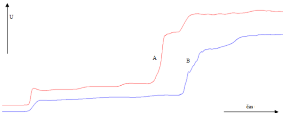
Obrázek 30: Izotachoforetické záznamy směsi prolinu (4,3 mM roztok) a hydroxyprolinu (3,8 mM roztok) bez barviva (A) a s barvivem (B). Elektrolytový systém I (pH 2,4)
