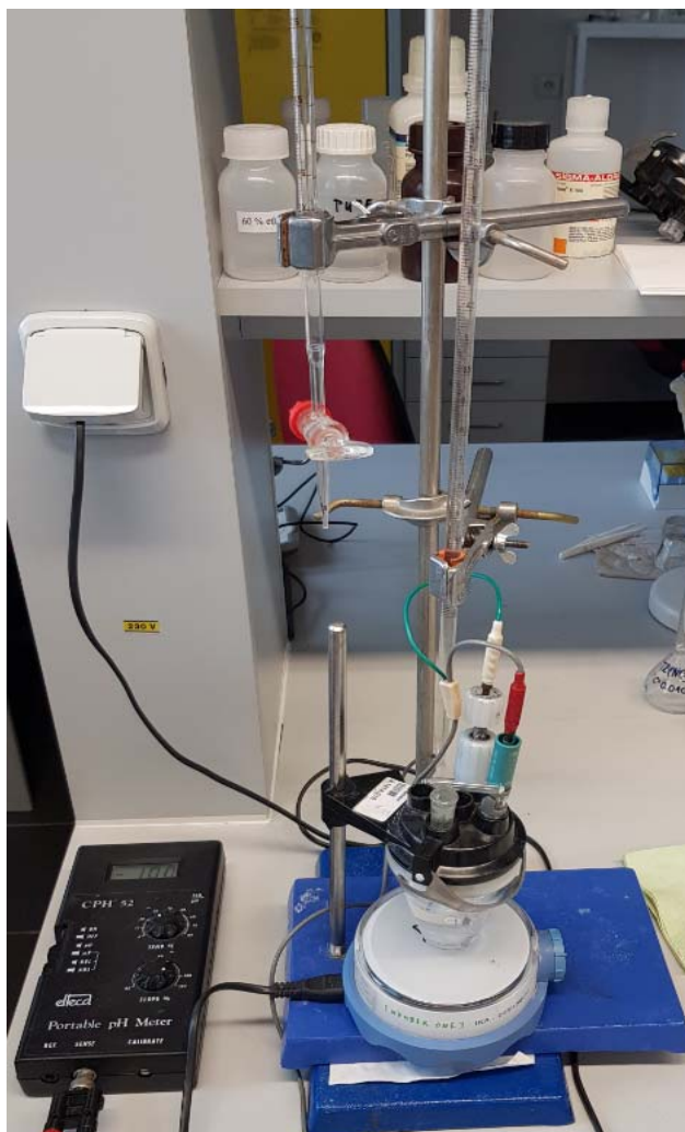
Obr. 5. Aparatura pro potenciometrické titrace – zleva: pH metr CPH 52, 10 ml byrety, referentní a indikační elektrody, pracovní nádoba a magnetické míchadlo
