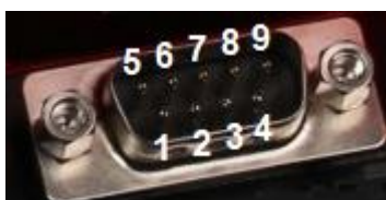
Obr. 3.2 – Cannon9, typické provedení RS-232
