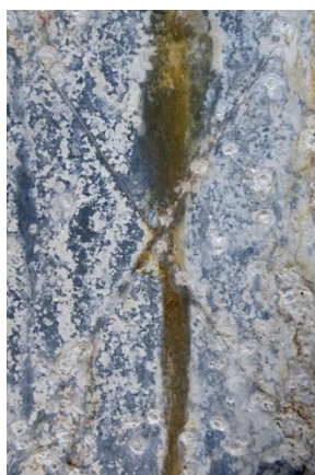
Nátěrové filmy s obsahem Zn_{iso} OKP = 63 % před expozicí, po expozici a po odstranění nátěru
