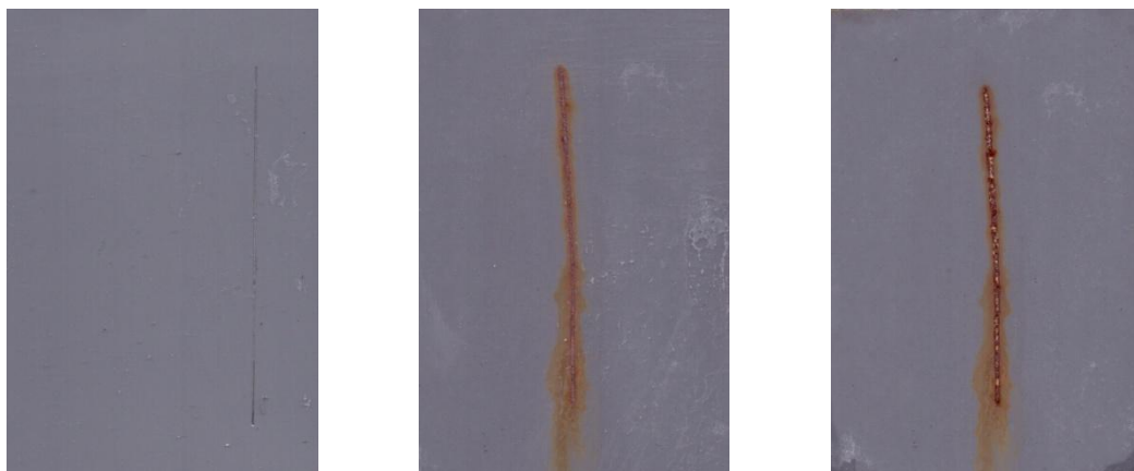
Nátěrové filmy s obsahem \text{MoS}_2\text{-PANI/Zn}_{\text{iso}} OKP = 3 % před expozicí, po 960 a 1680 hodinách expozice
