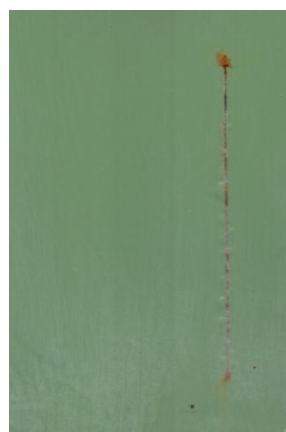
Nátěrové filmy s obsahem Mg OKP = 10 % před expozicí, po 960 hod expozice v atmosféře se solnou mlhou a se střídáním teplot
