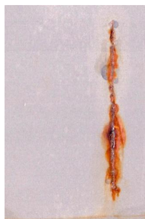
Nátěrové filmy s obsahem Mg OKP = 5 % před expozicí, po 240 hod a 720 hod expozice
