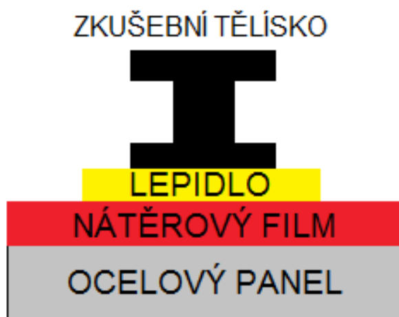
Obrázek 19 Schéma při odtrhové zkoušce přilnavosti
