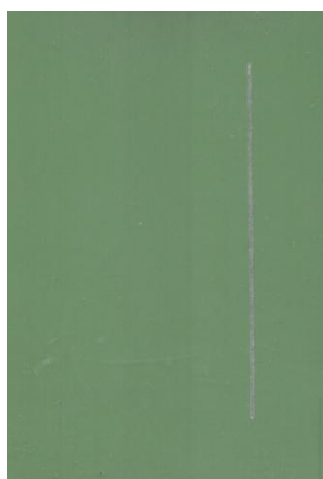
Nátěrové filmy s obsahem Mg OKP = 10 % před expozicí, po 960 hod expozice v atmosféře se solnou mlhou a se střídáním teplot
