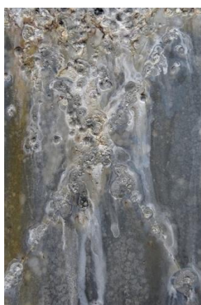
Nátěrové filmy s obsahem \text{WS}_2\text{-PPy/Zn}_{\text{iso}} OKP = 5 % před expozicí, po expozici a po odstranění nátěru
