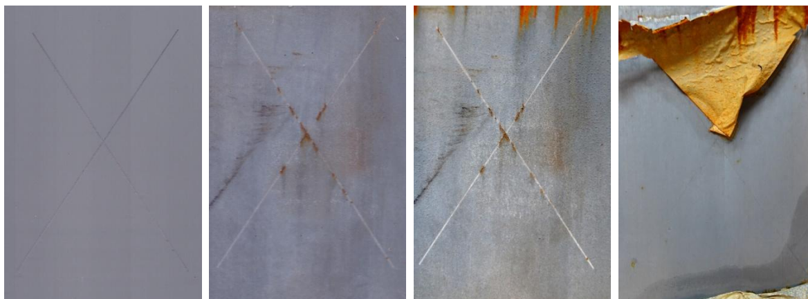
Nátěrové filmy s obsahem Mg/Zn iso OKP = 5 % před expozicí po 1., 2. a 3. cyklu
