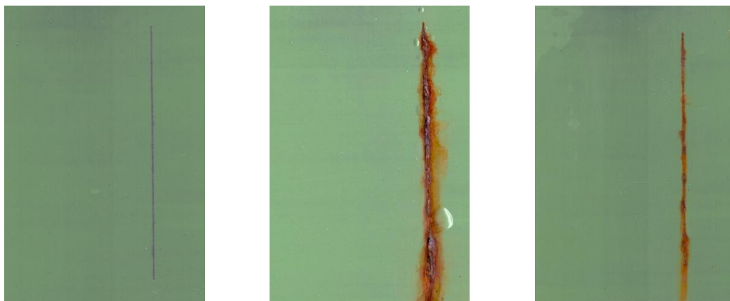
Nátěrové filmy s obsahem Zn lam OKP = 10 % před expozicí, po 960 hod expozice v atmosféře se solnou mlhou a se střídáním teplot
