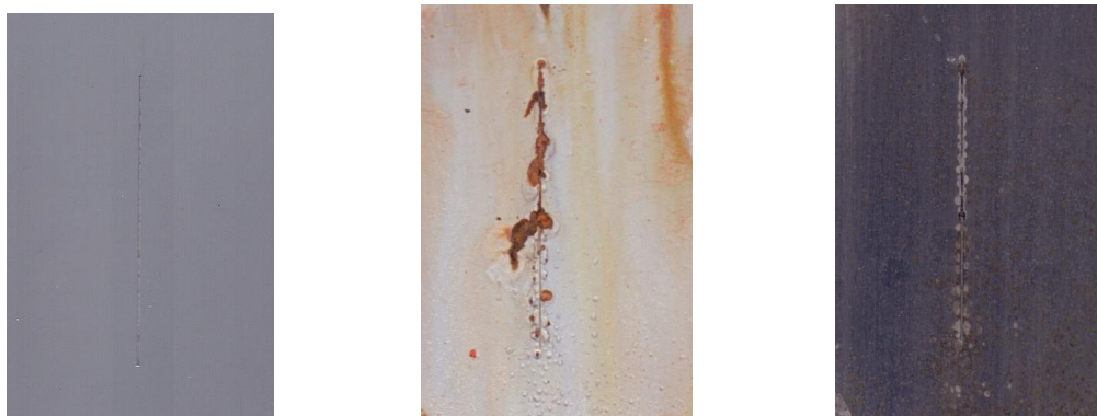
Obrázek 32 Snímky nátěrového filmu s obsahem Zn_{iso} při OKP_{Zn} = 61 \% před expozicí, po expozici a po odstranění nátěrového filmu
