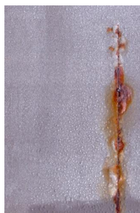
Nátěrové filmy s obsahem Mg OKP = 30 % před expozicí, po 240 hod a 720 hod expozice
