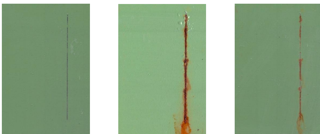
Nátěrové filmy s obsahem WS2-PANI/Zniso OKP = 5 % před expozicí, po 960 hod expozice v atmosféře se solnou mlhou a se střídáním teplot
