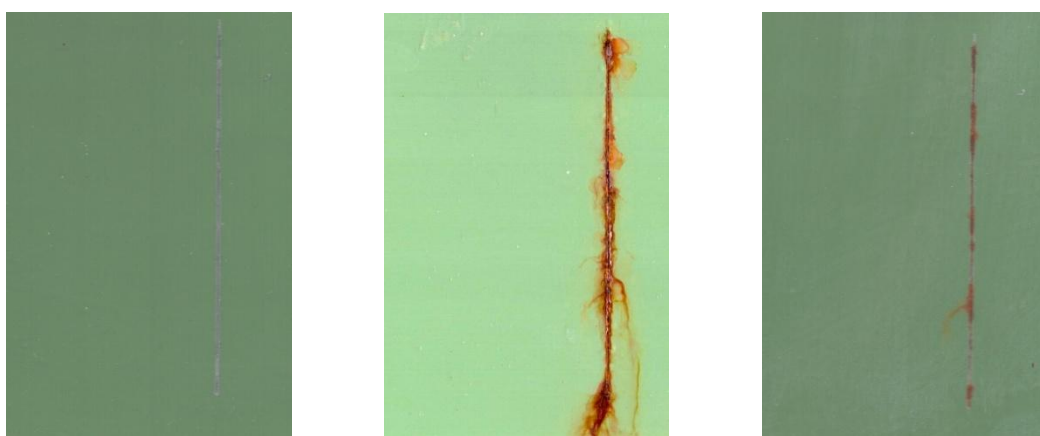
Nátěrové filmy s obsahem Zniso OKP = 10 % před expozicí, po 960 hod expozice v atmosféře se solnou mlhou a se střídáním teplot
