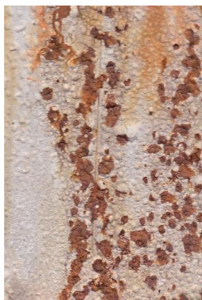
Nátěrové filmy s obsahem Zn (lam) OKP = 10 % před expozicí, po expozici a po odstranění nátěru
