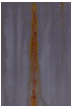
Nátěrové filmy s obsahem Zn (lam) OKP = 42 % před expozicí, po expozici a po odstranění nátěru
