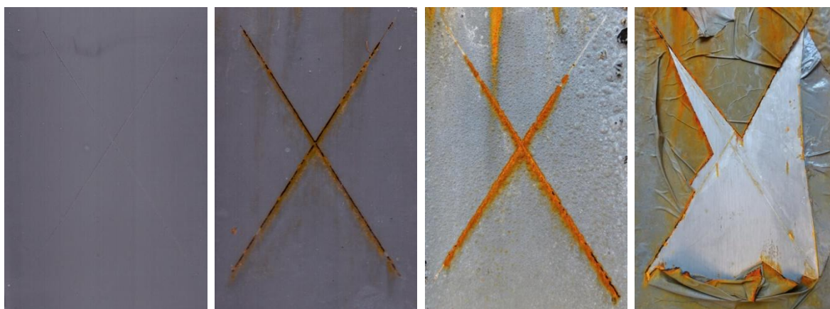
Nátěrové filmy s obsahem \text{MoS}_2\text{-PANI/Zn}_{\text{iso}} OKP = 5 % před expozicí po 1., 2. a 3. cyklu
