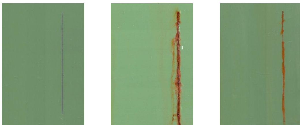
Nátěrové filmy s obsahem Zniso OKP = 30 % před expozicí, po 960 hod expozice v atmosféře se solnou mlhou a se střídáním teplot
