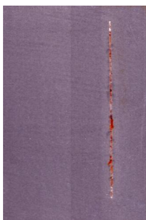
Nátěrové filmy s obsahem Mg OKP = 10 % před expozicí, po 240 hod a 720 hod expozice
