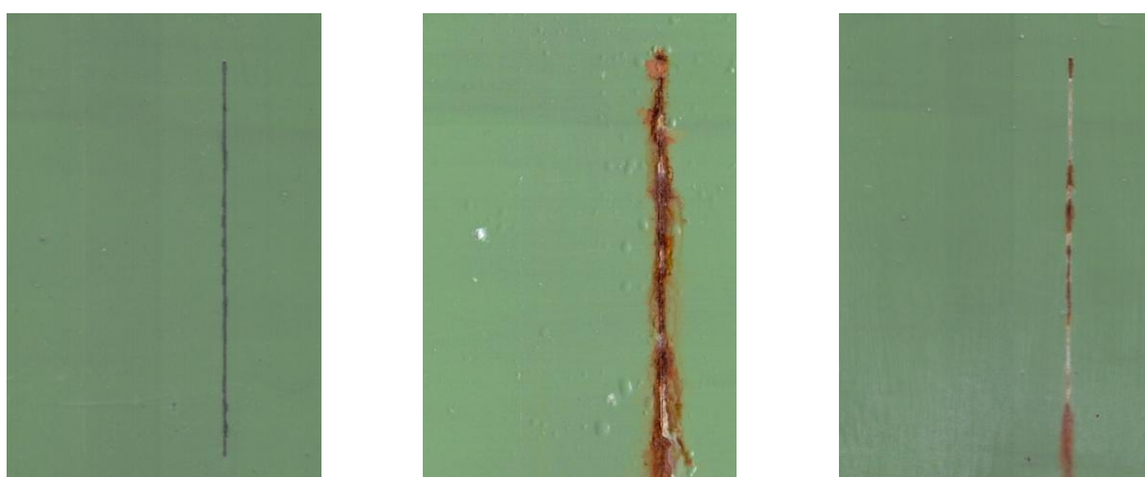
Nátěrové filmy s obsahem Zn lam OKP = 39 % před expozicí, po 960 hod expozice v atmosféře se solnou mlhou a se střídáním teplot
