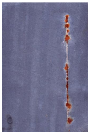
Nátěrové filmy s obsahem \text{MoS}_2\text{-PPy/Zn}_{\text{iso}} OKP = 3 % před expozicí, po 240 hod a 720 hod expozice
