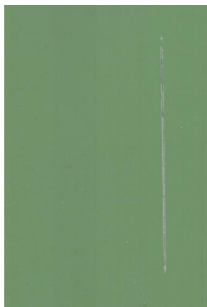
Nátěrové filmy s obsahem Mg OKP = 1 % před expozicí, po 960 hod expozice v atmosféře se solnou mlhou a se střídáním teplot
