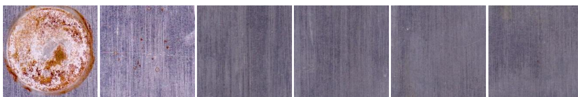
Nátěrové filmy s obsahem \text{WS}_2\text{-PPy/Zn}_{\text{iso}} OKP = 3 %
