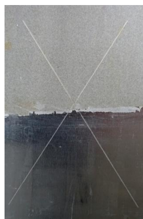
Nátěrové filmy s obsahem Mg OKP = 5 % před expozicí, po expozici a po odstranění nátěru
