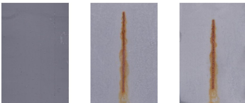
Nátěrové filmy s obsahem \text{WS}_2\text{-PPy/Zn}_{\text{iso}} OKP = 1 % před expozicí, po 960 a 1680 hodinách expozice
