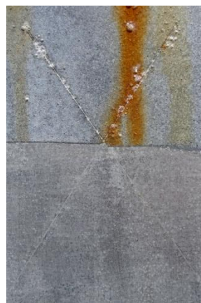
Nátěrové filmy s obsahem \text{Mg/Zn}_{\text{lam}} OKP = 10 % před expozicí, po expozici a po odstranění nátěru
