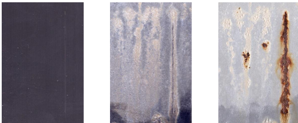
Nátěrové filmy s obsahem Zn_{lam} OKP = 42 % před expozicí, po 240 hod a 720 hod expozice
