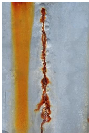
Nátěrové filmy s obsahem WS_2 -PPy/ Zn_{iso} OKP = 3 % před expozicí, po expozici a po odstranění nátěru
