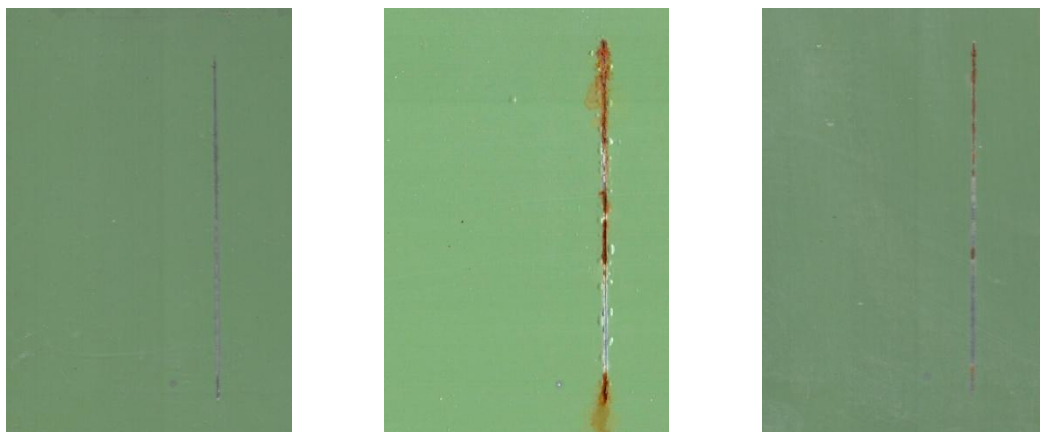
Nátěrové filmy s obsahem Mg/Zniso OKP = 5 % před expozicí, po 960 hod expozice v atmosféře se solnou mlhou a se střídáním teplot
