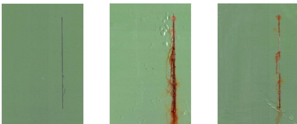
Nátěrové filmy s obsahem MoS 2 -PPy/Zniso OKP = 5 % před expozicí, po 960 hod expozice v atmosféře se solnou mlhou a se střídáním teplot
