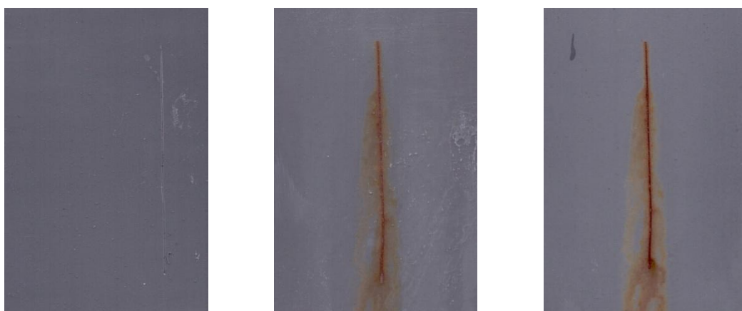
Nátěrové filmy s obsahem \text{WS}_2\text{-PANI/Zn}_{\text{iso}} OKP = 5 % před expozicí, po 960 a 1680 hodinách expozice
