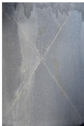
Nátěrové filmy s obsahem Mg OKP = 56 % před expozicí, po expozici a po odstranění nátěru
