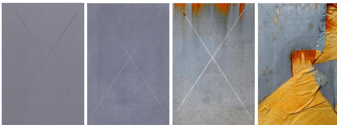
Nátěrové filmy s obsahem Mg/Zn iso OKP = 10 % před expozicí po 1., 2. a 3. cyklu
