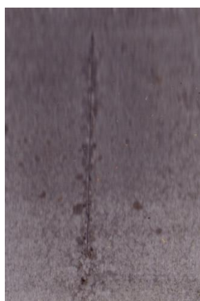
Nátěrové filmy s obsahem Mg / Zn (lam) OKP = 3 % před expozicí, po expozici a po odstranění nátěru
