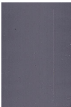
Nátěrové filmy s obsahem \text{MoS}_2\text{-PPy/Zn}_{\text{iso}} OKP = 5 % před expozicí, po 240 hod a 720 hod expozice
