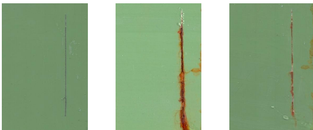
Nátěrové filmy s obsahem WS 2 -PPy/Zniso OKP = 1 % před expozicí, po 960 hod expozice v atmosféře se solnou mlhou a se střídáním teplot
