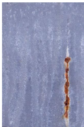
Nátěrové filmy s obsahem \text{MoS}_2\text{-PANI/Zn}_{\text{iso}} OKP = 3 % před expozicí, po 240 hod a 720 hod expozice
