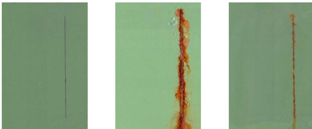
Nátěrové filmy s obsahem WS2-PANI/Zniso OKP = 3 % před expozicí, po 960 hod expozice v atmosféře se solnou mlhou a se střídáním teplot
