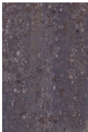
Nátěrové filmy s obsahem Zn (lam) OKP = 10 % před expozicí, po expozici a po odstranění nátěru
