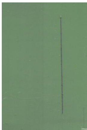
Nátěrové filmy s obsahem WS2-PPy/Zniso OKP = 3 % před expozicí, po 960 hod expozice v atmosféře se solnou mlhou a se střídáním teplot
