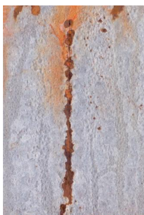
Nátěrové filmy s obsahem Mg / Zn (lam) OKP = 3 % před expozicí, po expozici a po odstranění nátěru
