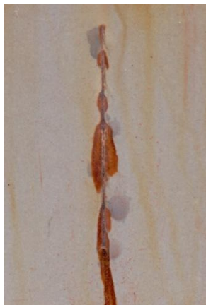
Nátěrové filmy s obsahem Mg OKP = 1 % před expozicí, po expozici a po odstranění nátěru
