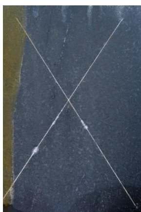
Nátěrové filmy s obsahem Mg/Zn 180 OKP = 10 % před expozicí, po expozici a po odstranění nátěru
