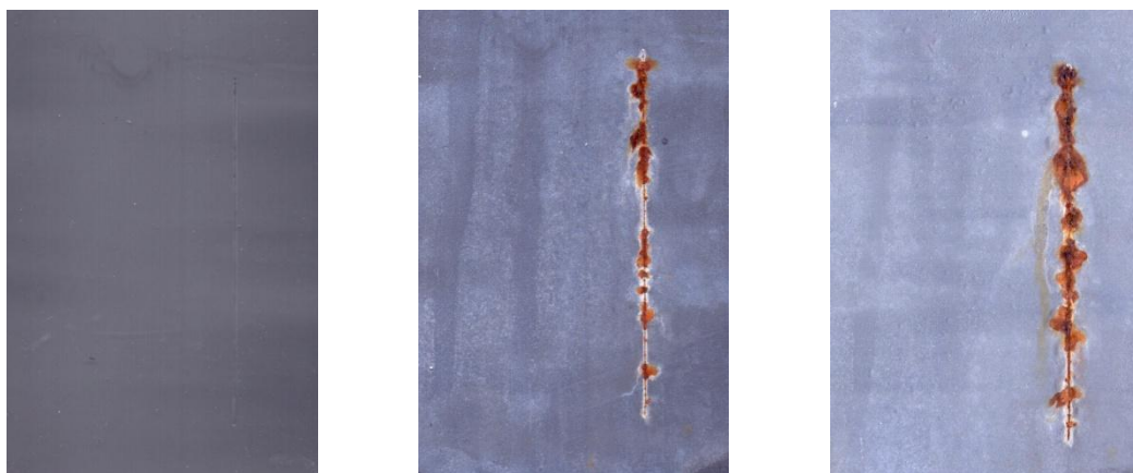
Nátěrové filmy s obsahem \text{MoS}_2\text{-PPy/Zn}_{\text{iso}} OKP = 1 % před expozicí, po 240 hod a 720 hod expozice
