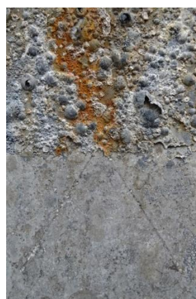
Nátěrové filmy s obsahem \text{MoS}_2\text{-PANI/Zn}_{\text{iso}} OKP = 5 % před expozicí, po expozici a po odstranění nátěru
