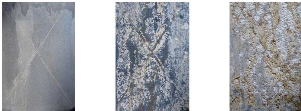
Obrázek 36 Nátěrové filmy s obsahem Mg, Zn_{iso} a Zn_{lam} (zleva) při OKP = KOKP po expozici v atmosféře s obsahem chloridu sodného
