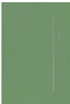
Nátěrové filmy s obsahem Mg OKP = 5 % před expozicí, po 960 hod expozice v atmosféře se solnou mlhou a se střídáním teplot
