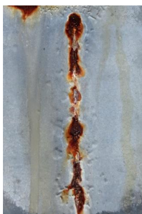
Nátěrové filmy s obsahem WS_2 -PPy/ Zn_{iso} OKP = 5 % před expozicí, po expozici a po odstranění nátěru
