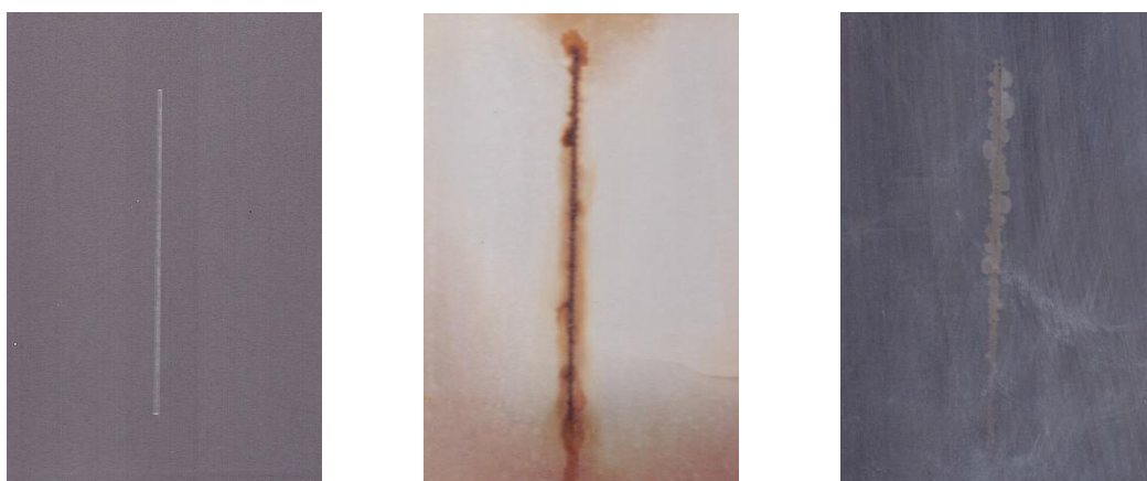
Nátěrové filmy s obsahem Mg OKP = 10 % před expozicí, po expozici a po odstranění nátěru
