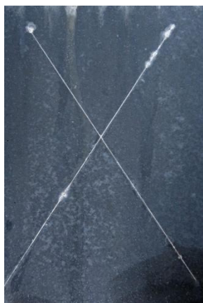
Nátěrové filmy s obsahem Mg/Zn 180 OKP = 5 % před expozicí, po expozici a po odstranění nátěru
