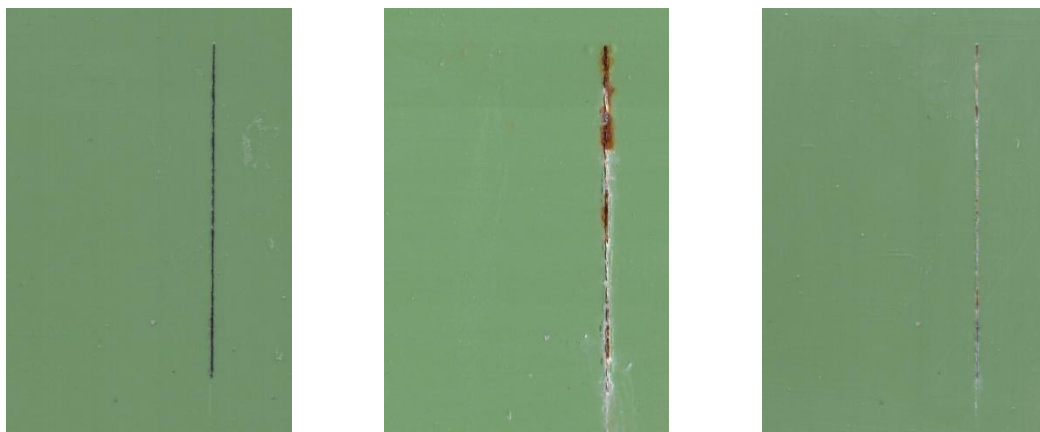
Nátěrové filmy s obsahem Mg/Zn lam OKP = 1 % před expozicí, po 960 hod expozice v atmosféře se olnou mlhou a se střídáním teplot
