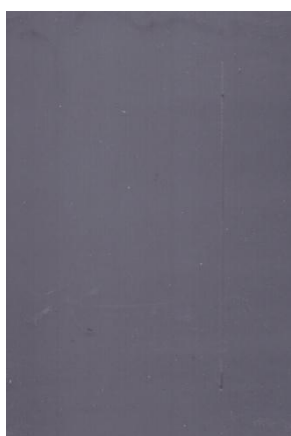
Nátěrové filmy s obsahem \text{MoS}_2\text{-PANI/Zn}_{\text{iso}} OKP = 5 % před expozicí, po 240 hod a 720 hod expozice
