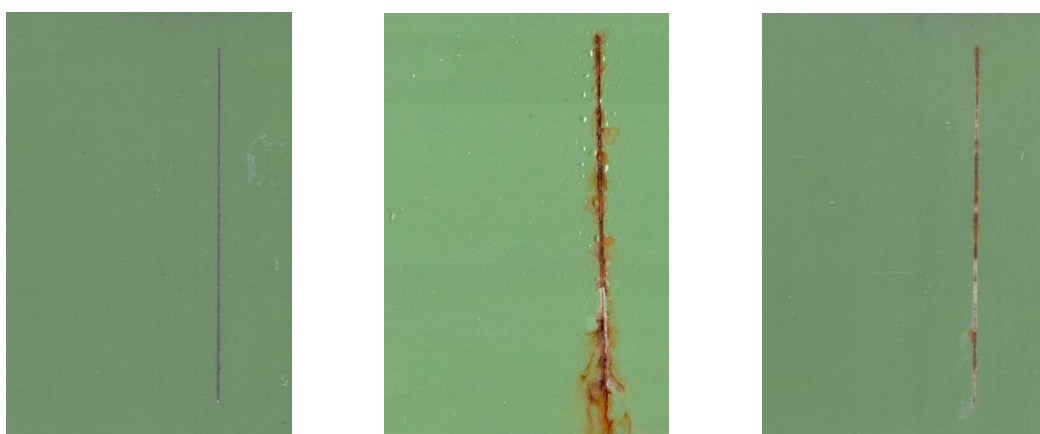
Nátěrové filmy s obsahem Mg/Zn iso OKP = 3 % před expozicí, po 960 hod expozice v atmosféře se solnou mlhou a se střídáním teplot
