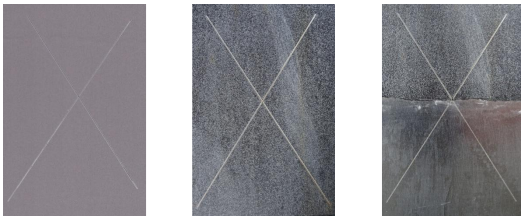
Nátěrové filmy s obsahem Zn_{lam} OKP = 10 % před expozicí, po expozici a po odstranění nátěru
