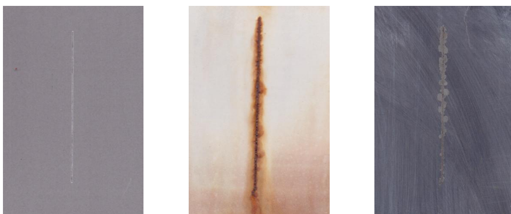
Nátěrové filmy s obsahem Mg OKP = 5 % před expozicí, po expozici a po odstranění nátěru
