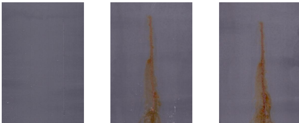
Nátěrové filmy s obsahem \text{MoS}_2\text{-PPy/Zn}_{\text{iso}} OKP = 3 % před expozicí, po 960 a 1680 hodinách expozice
