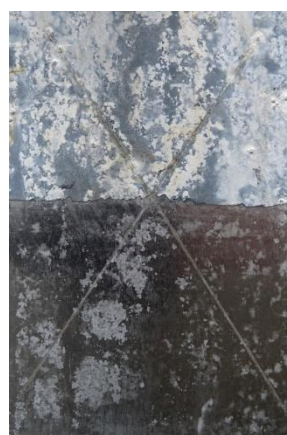
Nátěrové filmy s obsahem Zn_{iso} OKP = 61 % před expozicí, po expozici a po odstranění nátěru
