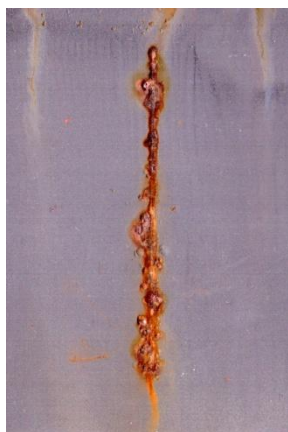
Nátěrové filmy s obsahem Mg / Zn (lam) OKP = 10 % před expozicí, po expozici a po odstranění nátěru
