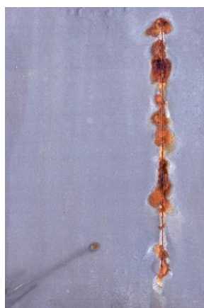
Nátěrové filmy s obsahem \text{MoS}_2\text{-PPy/Zn}_{\text{iso}} OKP = 5 % před expozicí, po 240 hod a 720 hod expozice
