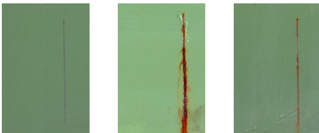
Nátěrové filmy s obsahem WS 2 -PANI/Zniso OKP = 1 % před expozicí, po 960 hod expozice v atmosféře se solnou mlhou a se střídáním teplot
