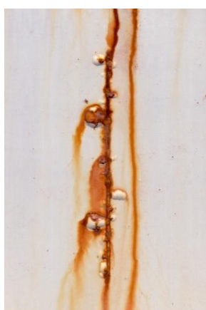
Nátěrové filmy s obsahem Zn (iso) OKP = 30 % před expozicí, po expozici a po odstranění nátěru
