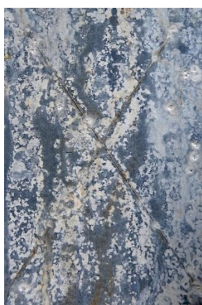
Nátěrové filmy s obsahem Zn_{iso} OKP = 61 % před expozicí, po expozici a po odstranění nátěru
