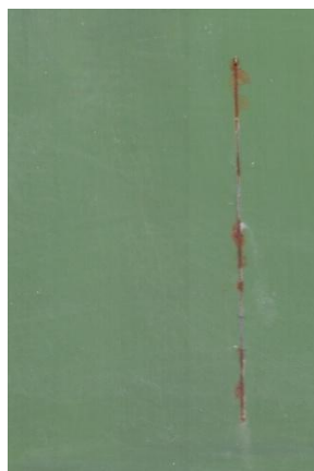
Nátěrové filmy s obsahem WS2-PPy/Zniso OKP = 3 % před expozicí, po 960 hod expozice v atmosféře se solnou mlhou a se střídáním teplot
