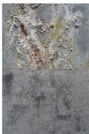
Nátěrové filmy s obsahem MoS_2 -PPy/ Zn_{iso} OKP = 1 % před expozicí, po expozici a po odstranění nátěru
