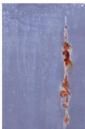
Nátěrové filmy s obsahem \text{MoS}_2\text{-PANI/Zn}_{\text{iso}} OKP = 5 % před expozicí, po 240 hod a 720 hod expozice
