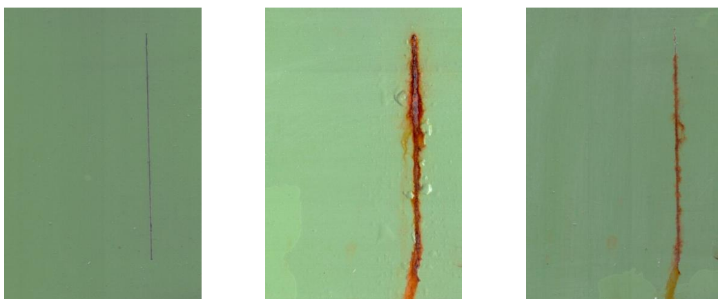
Nátěrové filmy s obsahem MoS2-PANI/Zniso OKP = 1 % před expozicí, po 960 hod expozice v atmosféře se solnou mlhou a se střídáním teplot
