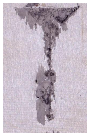
Nátěrové filmy s obsahem WS_2 -PPy/ Zn_{iso} OKP = 5 % před expozicí, po expozici a po odstranění nátěru
