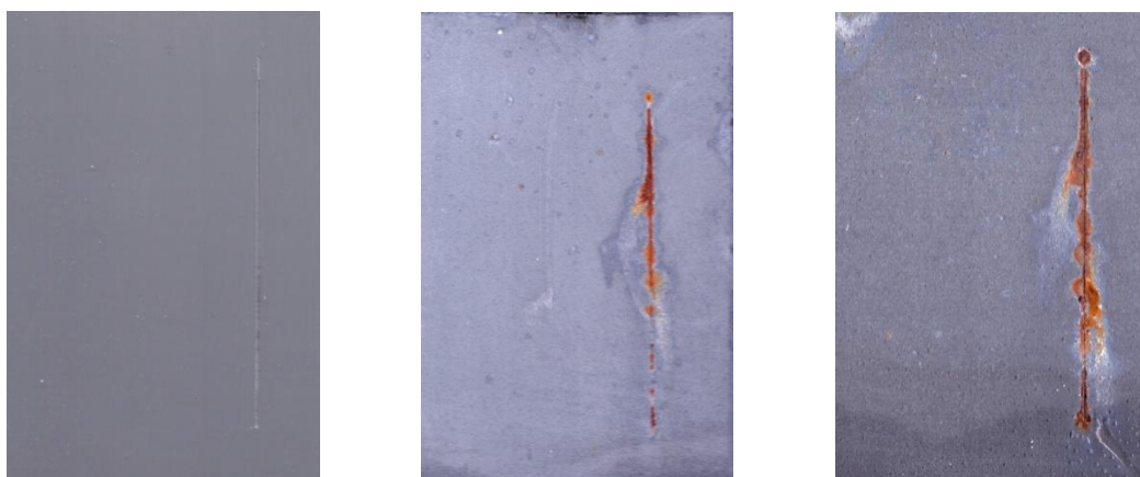
Nátěrové filmy s obsahem Mg/Zn iso OKP = 10 % před expozicí, po 240 hod a 720 hod expozice
