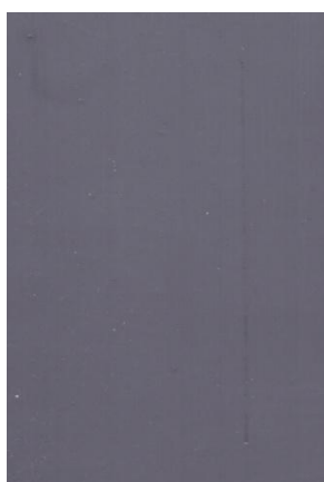
Nátěrové filmy s obsahem WS_2 -PPy/ Zn_{iso} OKP = 5 % před expozicí, po expozici a po odstranění nátěru
