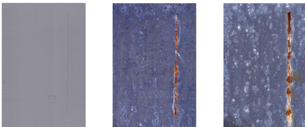
Nátěrové filmy s obsahem Mg/Zn iso OKP = 1 % před expozicí, po 240 hod a 720 hod expozice
