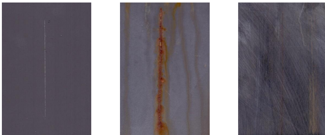
Nátěrové filmy s obsahem Mg / Zn (lam) OKP = 1 % před expozicí, po expozici a po odstranění nátěru
