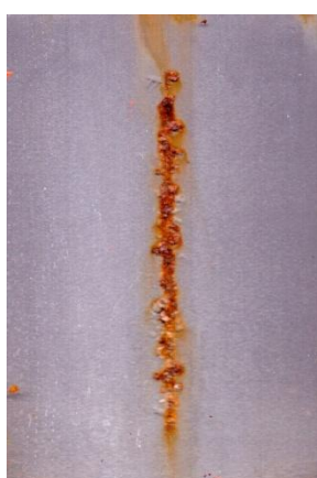
Nátěrové filmy s obsahem Zn (lam) OKP = 39 % před expozicí, po expozici a po odstranění nátěru
