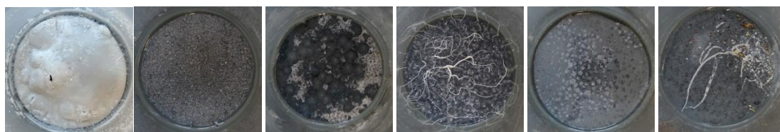
Obrázek 37 Korozní projevy při různých pH pufrů (zleva pH = 2, 4, 6, 8, 10 a 12) u srovnávacího nátěru Zn_{iso} při OKP_{Zn} = 61 \%
