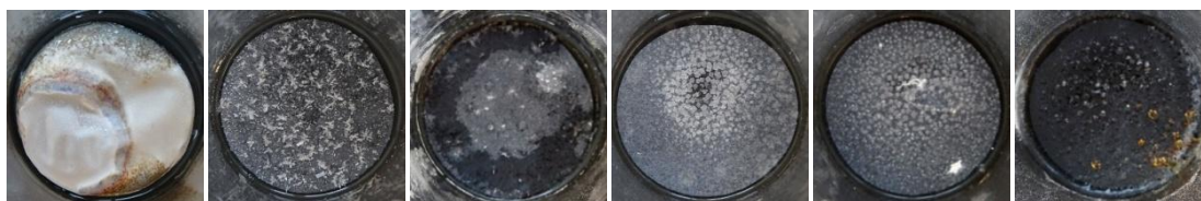
Obrázek 38 Korozní projevy při různých pH pufrů (zleva pH = 2, 4, 6, 8, 10 a 12) u srovnávacího nátěru Zn_{lam} při OKP_{Zn} = 39 \%
