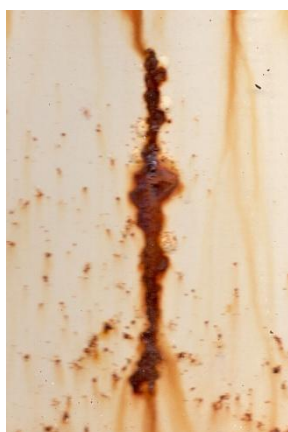
Nátěrové filmy s obsahem Mg OKP = 15 % před expozicí, po expozici a po odstranění nátěru
