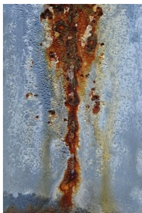
Nátěrové filmy s obsahem \text{MoS}_2\text{-PANI/Zn}_{\text{iso}} OKP = 3 % před expozicí, po expozici a po odstranění nátěru
