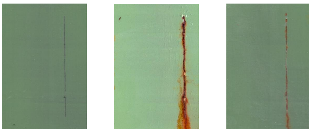
Nátěrové filmy s obsahem MoS 2 -PANI/Zniso OKP = 5 % před expozicí, po 960 hod expozice v atmosféře se solnou mlhou a se střídáním teplot
