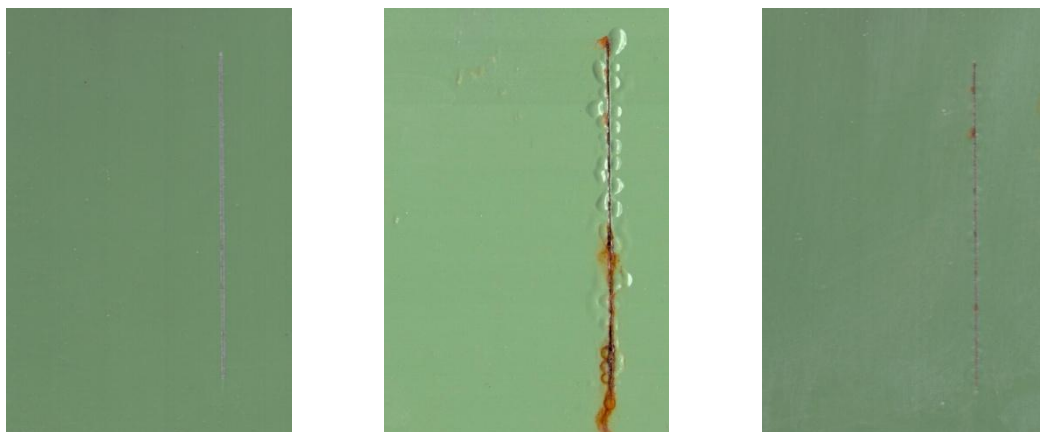
Nátěrové filmy s obsahem Mg OKP = 15 % před expozicí, po 960 hod expozice v atmosféře se solnou mlhou a se střídáním teplot
