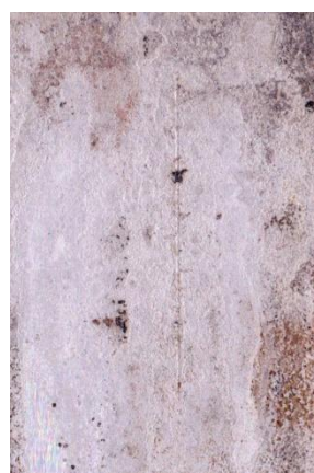
Nátěrové filmy s obsahem Mg OKP = 50 % před expozicí, po expozici a po odstranění nátěru
