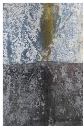
Nátěrové filmy s obsahem Zn_{iso} OKP = 63 % před expozicí, po expozici a po odstranění nátěru
