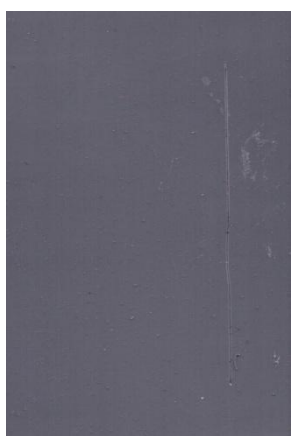
Nátěrové filmy s obsahem WS_2 -PANI/ Zn_{iso} OKP = 5 % před expozicí, po expozici a po odstranění nátěru
