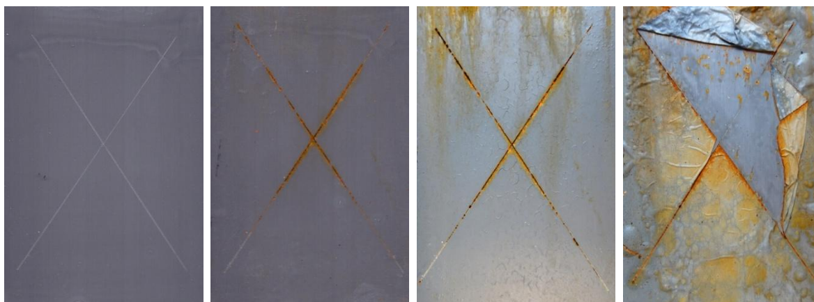
Nátěrové filmy s obsahem \text{MoS}_2\text{-PPy/Zn}_{\text{iso}} OKP = 1 % před expozicí po 1., 2. a 3. cyklu
