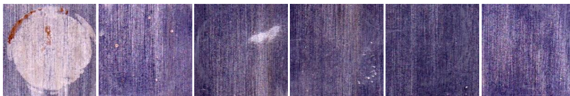
Nátěrové filmy s obsahem \text{MoS}_2\text{-PPy/Zn}_{\text{iso}} OKP = 3 %
