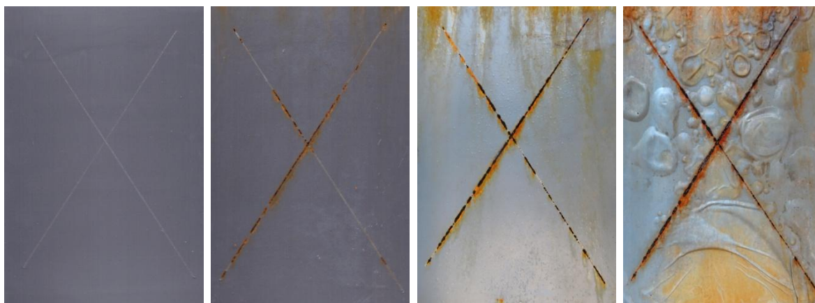
Nátěrové filmy s obsahem \text{WS}_2\text{-PANI/Zn}_{\text{iso}} OKP = 1 % před expozicí po 1., 2. a 3. cyklu
