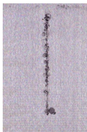
Nátěrové filmy s obsahem WS_2 -PANI/ Zn_{iso} OKP = 5 % před expozicí, po expozici a po odstranění nátěru
