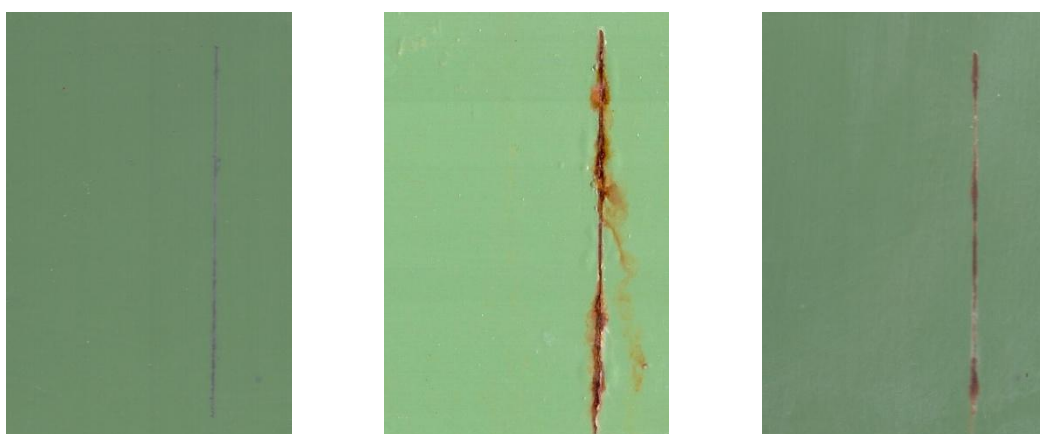
Nátěrové filmy s obsahem Zniso OKP = 63 % před expozicí, po 960 hod expozice v atmosféře se solnou mlhou a se střídáním teplot
