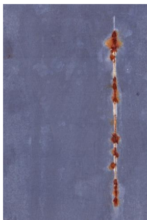
Nátěrové filmy s obsahem WS_2 -PPy/ Zn_{iso} OKP = 3 % před expozicí, po 240 hod a 720 hod expozice
