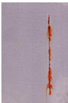
Nátěrové filmy s obsahem Mg OKP = 5 % před expozicí, po 240 hod a 720 hod expozice
