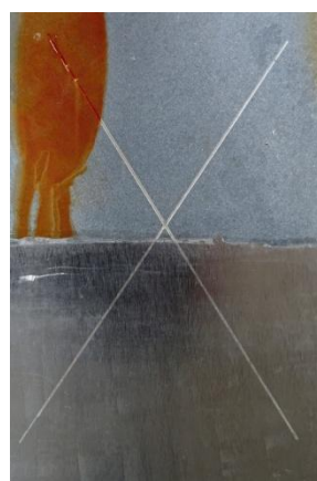
Nátěrové filmy s obsahem Zn iso OKP = 10 % před expozicí, po expozici a po odstranění nátěru
