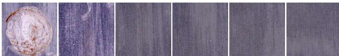
Nátěrové filmy s obsahem \text{MoS}_2\text{-PPy/Zn}_{\text{iso}} OKP = 5 %
