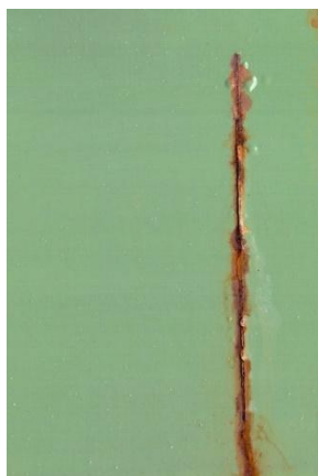
Nátěrové filmy s obsahem WS2-PPy/Zniso OKP = 3 % před expozicí, po 960 hod expozice v atmosféře se solnou mlhou a se střídáním teplot
