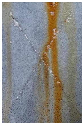
Nátěrové filmy s obsahem \text{Mg/Zn}_{\text{lam}} OKP = 10 % před expozicí, po expozici a po odstranění nátěru
