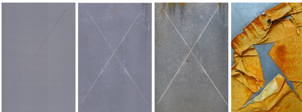
Nátěrové filmy s obsahem Mg/Zn iso OKP = 1 % před expozicí po 1., 2. a 3. cyklu
