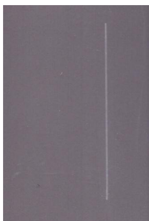
Nátěrové filmy s obsahem Mg OKP = 10 % před expozicí, po 240 hod a 720 hod expozice
