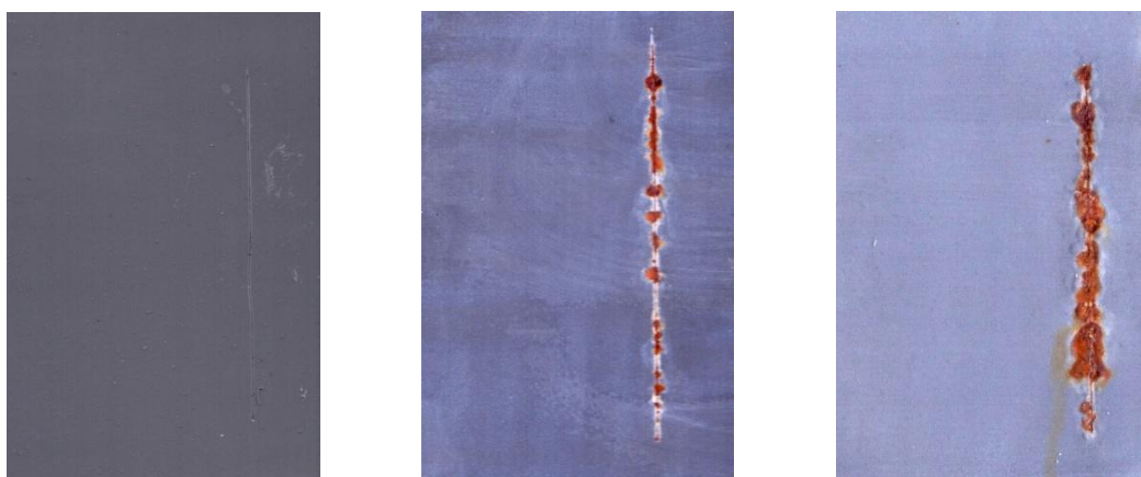
Nátěrové filmy s obsahem \text{WS}_2\text{-PANI/Zn}_{\text{iso}} OKP = 5 % před expozicí, po 240 hod a 720 hod expozice
