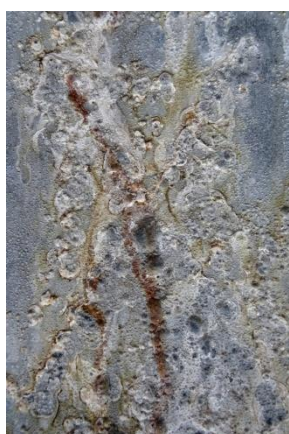
Nátěrové filmy s obsahem MoS_2 -PPy/ Zn_{iso} OKP = 1 % před expozicí, po expozici a po odstranění nátěru
