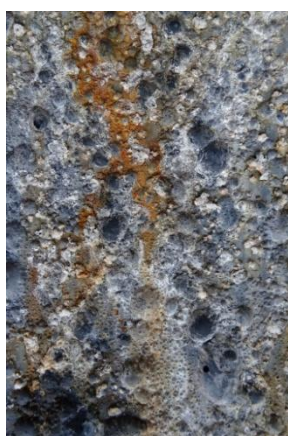
Nátěrové filmy s obsahem \text{MoS}_2\text{-PANI/Zn}_{\text{iso}} OKP = 5 % před expozicí, po expozici a po odstranění nátěru
