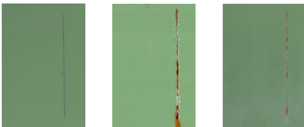
Nátěrové filmy s obsahem Mg/Zniso OKP = 10 % před expozicí, po 960 hod expozice v atmosféře se solnou mlhou a se střídáním teplot
