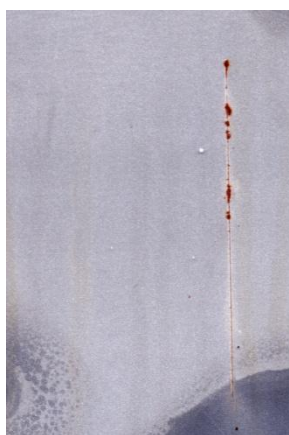
Nátěrové filmy s obsahem Zn_{lam} OKP = 30 % před expozicí, po 240 hod a 720 hod expozice
