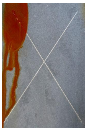
Nátěrové filmy s obsahem Zn iso OKP = 10 % před expozicí, po expozici a po odstranění nátěru
