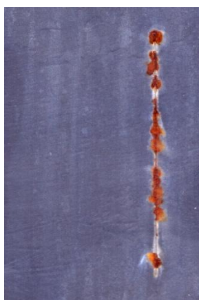
Nátěrové filmy s obsahem \text{MoS}_2\text{-PPy/Zn}_{\text{iso}} OKP = 5 % před expozicí, po 240 hod a 720 hod expozice
