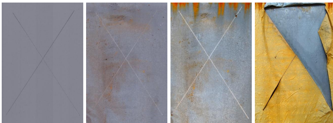
Nátěrové filmy s obsahem Mg/Zn iso OKP = 15 % před expozicí po 1., 2. a 3. cyklu
