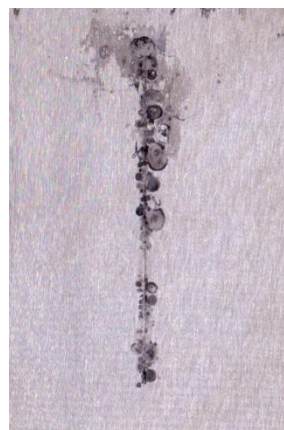
Nátěrové filmy s obsahem WS_2 -PPy/ Zn_{iso} OKP = 3 % před expozicí, po expozici a po odstranění nátěru
