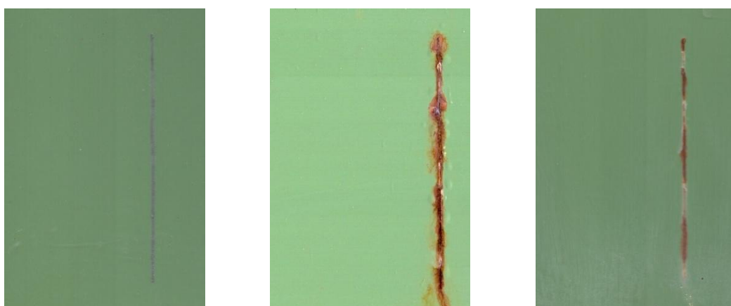
Nátěrové filmy s obsahem Zniso OKP = 61 % před expozicí, po 960 hod expozice v atmosféře se solnou mlhou a se střídáním teplot
