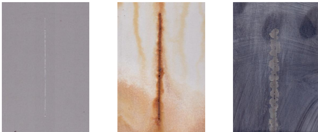
Nátěrové filmy s obsahem Mg OKP = 1 % před expozicí, po expozici a po odstranění
