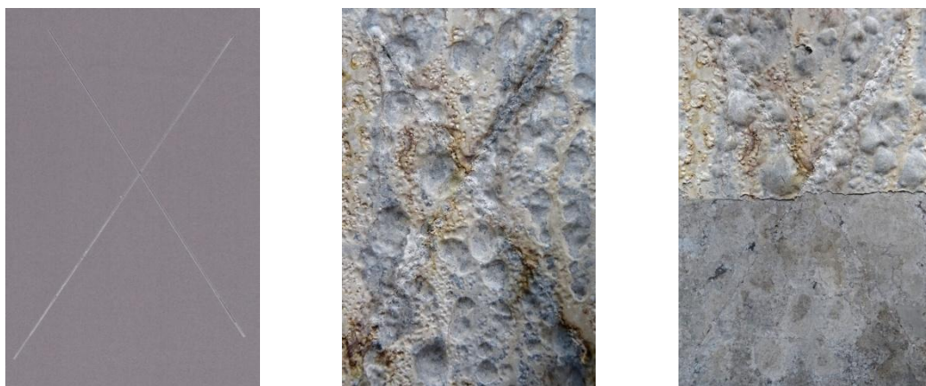
Nátěrové filmy s obsahem Zn_{lam} OKP = 39 % před expozicí, po expozici a po odstranění nátěru
