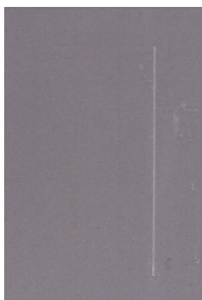
Nátěrové filmy s obsahem Mg OKP = 5 % před expozicí, po 240 hod a 720 hod expozice
