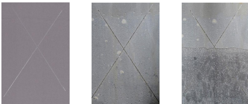
Nátěrové filmy s obsahem Zn_{lam} OKP = 30 % před expozicí, po expozici a po odstranění nátěru
