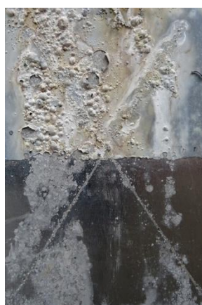
Nátěrové filmy s obsahem \text{WS}_2\text{-PPy/Zn}_{\text{iso}} OKP = 1 % před expozicí, po expozici a po odstranění nátěru
