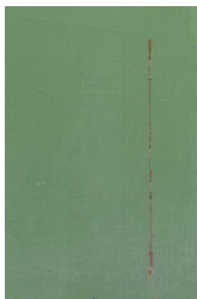
Nátěrové filmy s obsahem WS2-PPy/Zniso OKP = 5 % před expozicí, po 960 hod expozice v atmosféře se solnou mlhou a se střídáním teplot
