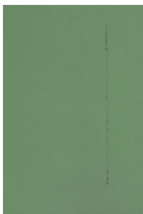
Nátěrové filmy s obsahem WS2-PPy/Zniso OKP = 5 % před expozicí, po 960 hod expozice v atmosféře se solnou mlhou a se střídáním teplot
