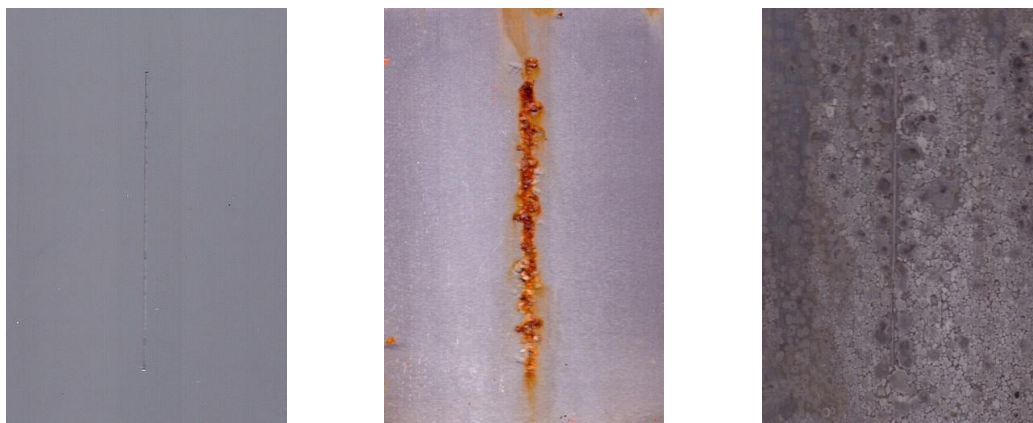
Obrázek 35 Snímky nátěrového filmu s obsahem Zn_{lam} při OKP_{Zn} = 39\% před expozicí, po expozici a po odstranění nátěrového filmu
