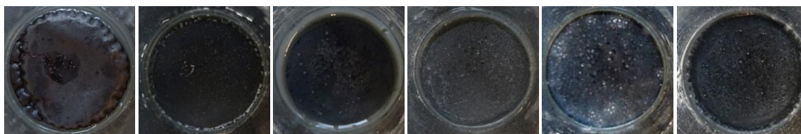
Nátěrové filmy s obsahem \text{MoS}_2\text{-PPy/Zn}_{\text{iso}} OKP = 5 %
