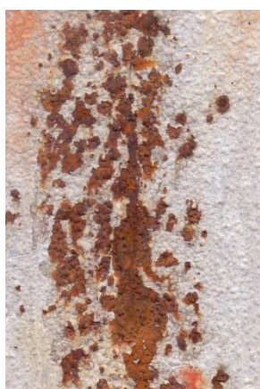
Nátěrové filmy s obsahem Mg / Zn (lam) OKP = 15 % před expozicí, po expozici a po odstranění nátěru
