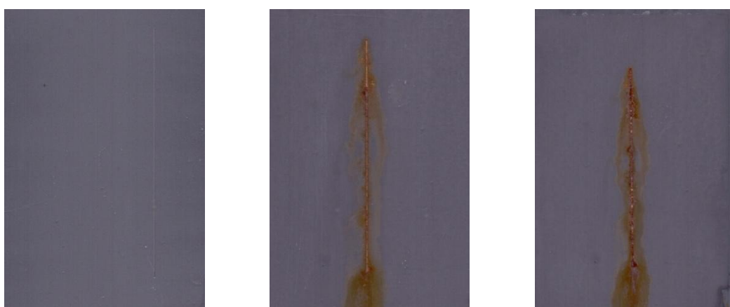
Nátěrové filmy s obsahem \text{MoS}_2\text{-PPy/Zn}_{\text{iso}} OKP = 5 % před expozicí, po 960 a 1680 hodinách expozice
