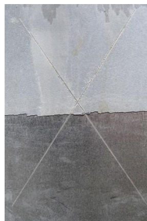
Nátěrové filmy s obsahem Mg OKP = 56 % před expozicí, po expozici a po odstranění nátěru
