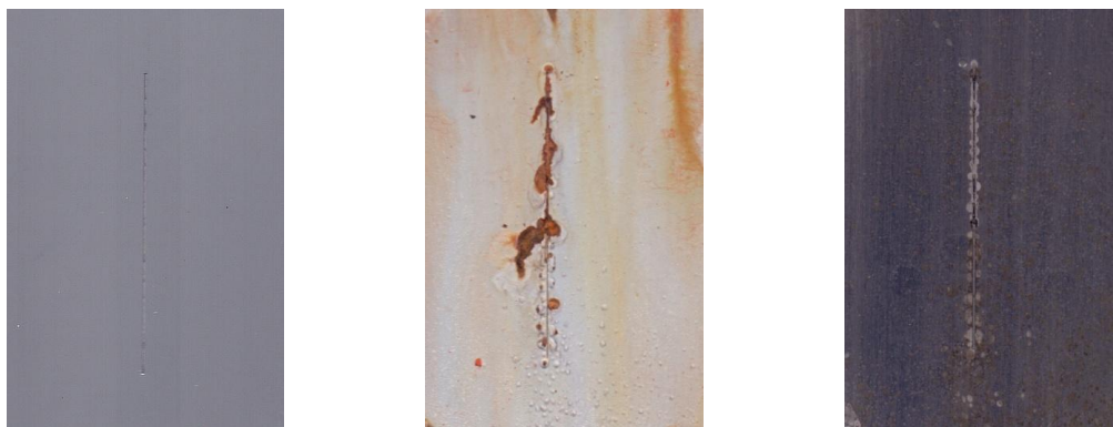
Obrázek 33 Snímky nátěrového filmu s obsahem Zn_{lam} při OKP_{Zn} = 39\% před expozicí, po expozici a po odstranění nátěrového filmu
