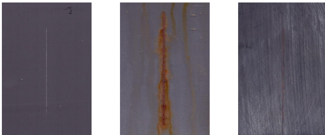
Nátěrové filmy s obsahem Mg / Zn (lam) OKP = 5 % před expozicí, po expozici a po odstranění nátěru
