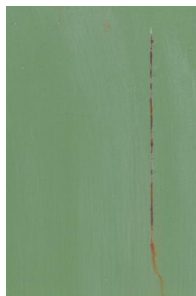
Nátěrové filmy s obsahem Mg OKP = 5 % před expozicí, po 960 hod expozice v atmosféře se solnou mlhou a se střídáním teplot
