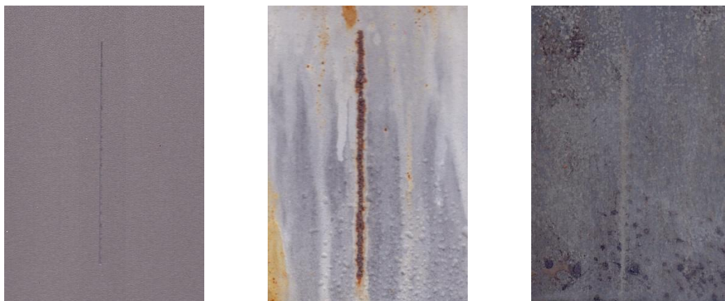
Nátěrové filmy s obsahem Mg OKP = 56 % před expozicí, po expozici a po odstranění nátěru
