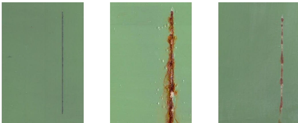
Nátěrové filmy s obsahem Zn lam OKP = 42 % před expozicí, po 960 hod expozice v atmosféře se solnou mlhou a se střídáním teplot
