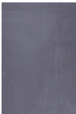
Nátěrové filmy s obsahem MoS 2 -PANI/Zn iso OKP = 1 % před expozicí, po expozici a po odstranění nátěru
