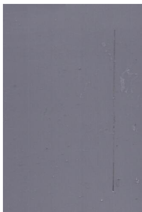
Nátěrové filmy s obsahem \text{MoS}_2\text{-PANI/Zn}_{\text{iso}} OKP = 3 % před expozicí, po 240 hod a 720 hod expozice
