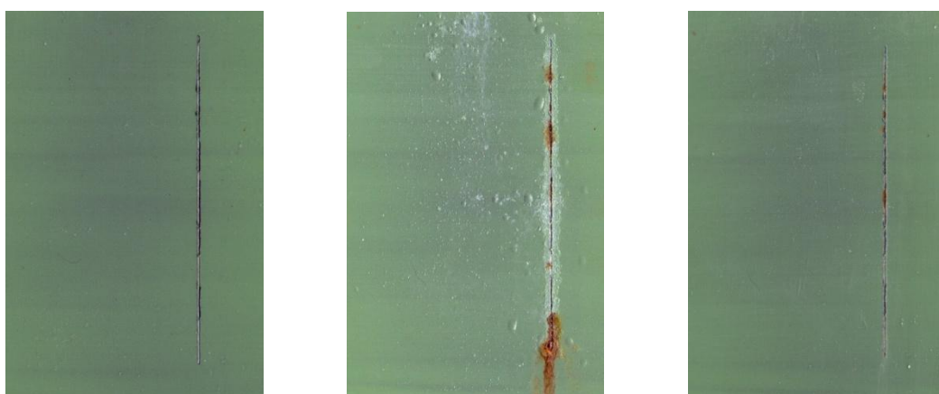
Nátěrové filmy s obsahem Mg/Znlam OKP = 15 % před expozicí, po 960 hod expozice v atmosféře se solnou mlhou a se střídáním teplot
