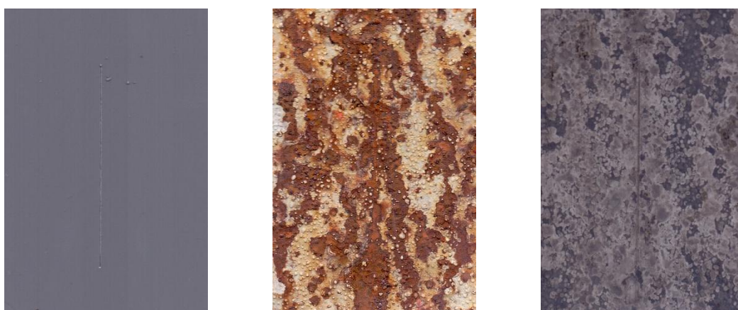
Nátěrové filmy s obsahem Zn (iso) OKP = 30 % před expozicí, po expozici a po odstranění nátěru
