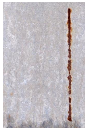
Nátěrové filmy s obsahem Mg/Zn_{lam} OKP = 1 % před expozicí, po 240 hod a 720 hod expozice
