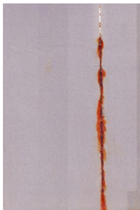
Nátěrové filmy s obsahem Mg OKP = 1 % před expozicí, po 240 hod a 720 hod expozice
