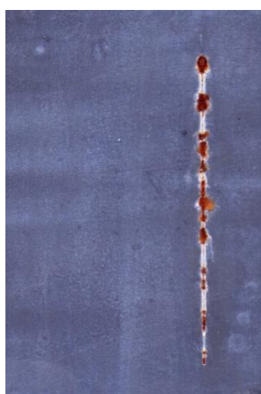
Nátěrové filmy s obsahem \text{MoS}_2\text{-PANI/Zn}_{\text{iso}} OKP = 5 % před expozicí, po 240 hod a 720 hod expozice
