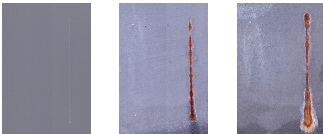
Nátěrové filmy s obsahem Mg/Zn iso OKP = 15 % před expozicí, po 240 hod a 720 hod expozice
