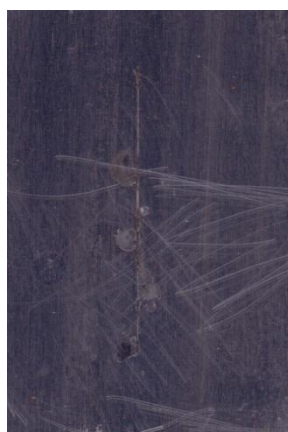
Nátěrové filmy s obsahem Mg OKP = 30 % před expozicí, po expozici a po odstranění nátěru
