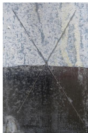
Nátěrové filmy s obsahem Zn_{iso} OKP = 50 % před expozicí, po expozici a po odstranění nátěru
