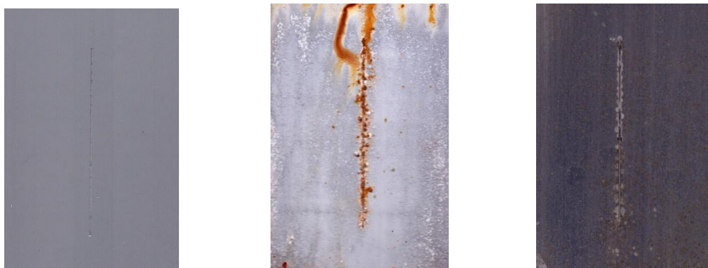
Obrázek 34 Snímky nátěrového filmu s obsahem Zn iso při OKP Zn = 61 % před expozicí, po expozici a po odstranění nátěrového filmu
