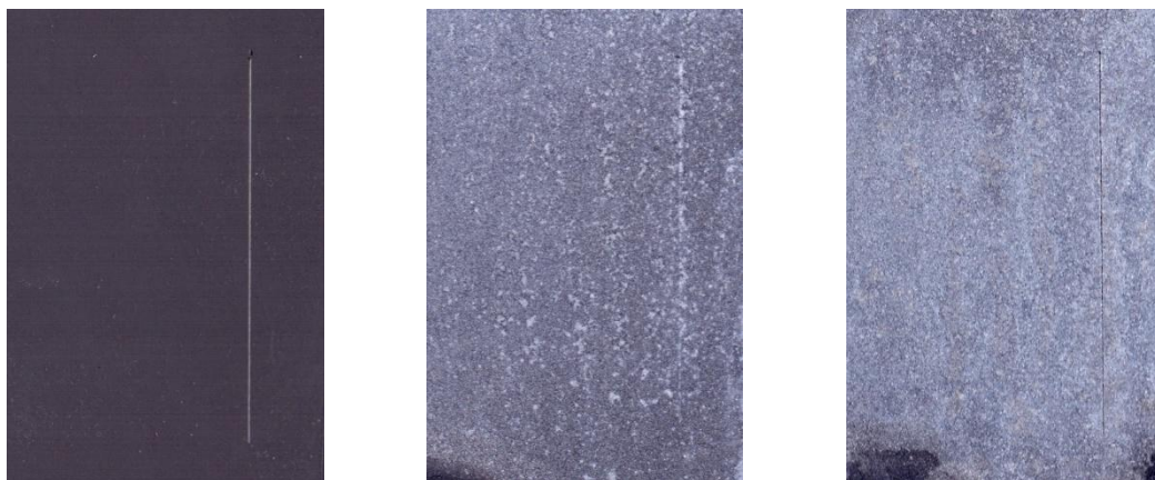
Nátěrové filmy s obsahem Mg/Zn lam OKP = 10 % před expozicí, po 240 hod a 720 hod expozice
