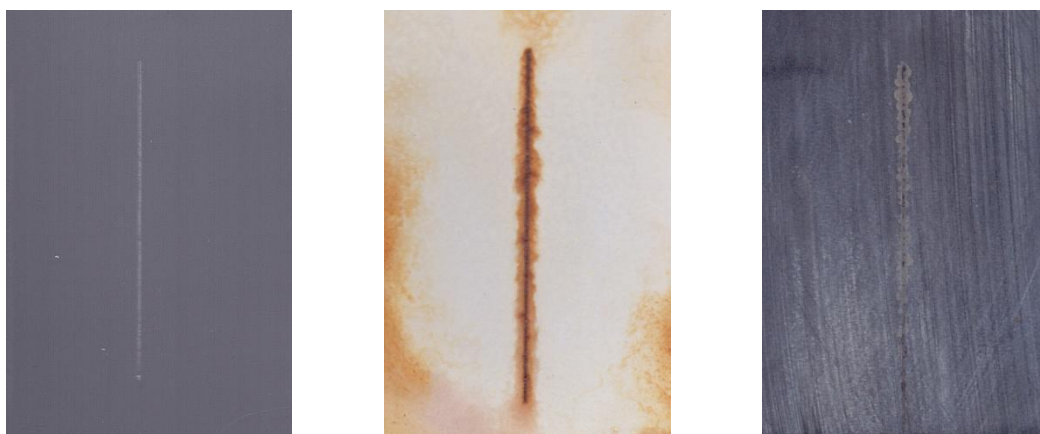
Nátěrové filmy s obsahem Zn (iso) OKP = 10 % před expozicí, po expozici a po odstranění nátěru
