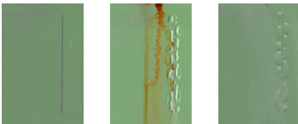
Nátěrové filmy s obsahem Mg OKP = 50 % před expozicí, po 960 hod expozice v atmosféře se solnou mlhou a se střídáním teplot
