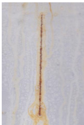
Nátěrové filmy s obsahem Mg / Zn (iso) OKP = 5 % před expozicí, po expozici a po odstranění nátěru
