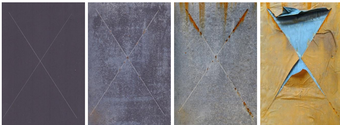
Nátěrové filmy s obsahem Mg/Zn_{lam} OKP = 1 % před expozicí po 1., 2. a 3. cyklu
