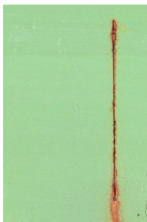
Nátěrové filmy s obsahem WS2-PPy/Zniso OKP = 5 % před expozicí, po 960 hod expozice v atmosféře se solnou mlhou a se střídáním teplot
