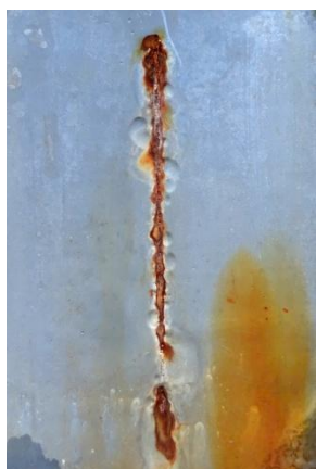
Nátěrové filmy s obsahem MoS 2 -PANI/Zn iso OKP = 1 % před expozicí, po expozici a po odstranění nátěru
