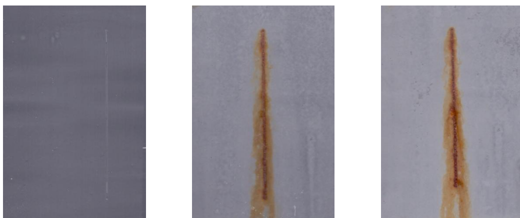
Nátěrové filmy s obsahem \text{WS}_2\text{-PANI/Zn}_{\text{iso}} OKP = 1 % před expozicí, po 960 a 1680 hodinách expozice
