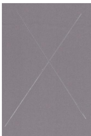
Nátěrové filmy s obsahem Zn iso OKP = 10 % před expozicí, po expozici a po odstranění nátěru
