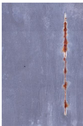
Nátěrové filmy s obsahem WS_2 -PPy/ Zn_{iso} OKP = 5 % před expozicí, po 240 hod a 720 hod expozice
