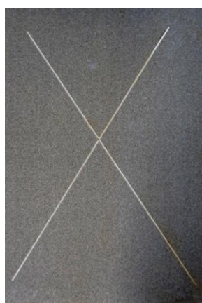
Nátěrové filmy s obsahem Mg OKP = 10 % před expozicí, po expozici a po odstranění nátěru
