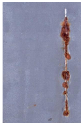
Nátěrové filmy s obsahem WS_2 -PPy/ Zn_{iso} OKP = 3 % před expozicí, po 240 hod a 720 hod expozice
