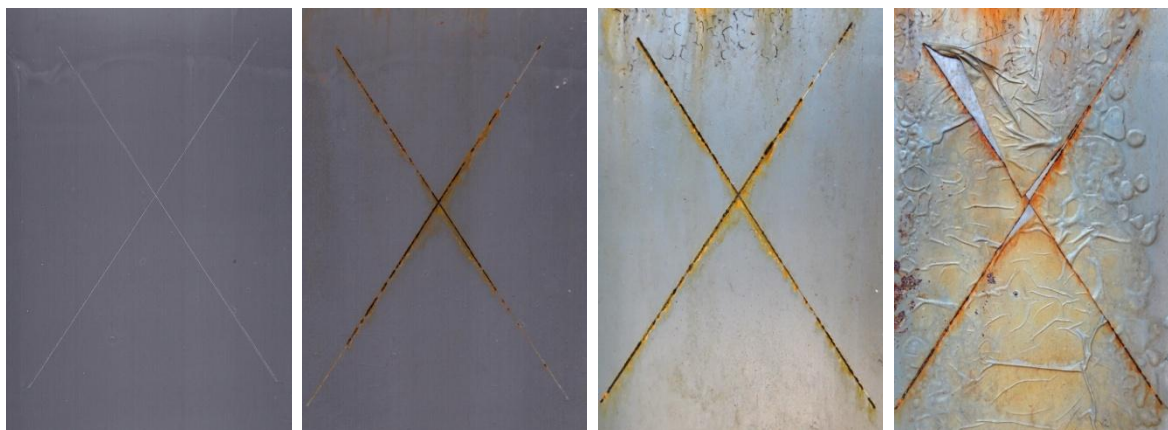
Nátěrové filmy s obsahem \text{WS}_2\text{-PANI/Zn}_{\text{iso}} OKP = 3 % před expozicí po 1., 2. a 3. cyklu
