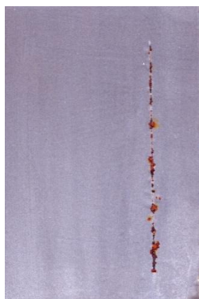
Nátěrové filmy s obsahem Mg OKP = 50 % před expozicí, po 240 hod a 720 hod expozice
