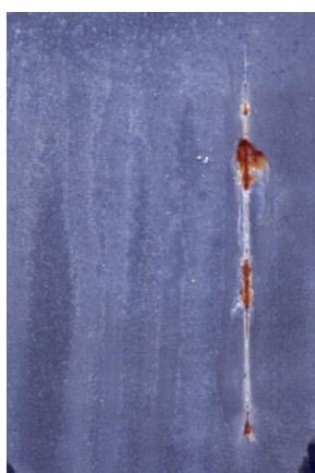
Nátěrové filmy s obsahem \text{WS}_2\text{-PANI/Zn}_{\text{iso}} OKP = 1 % před expozicí, po 240 hod a 720 hod expozice
