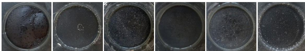
Nátěrové filmy s obsahem \text{MoS}_2\text{-PPy/Zn}_{\text{iso}} OKP = 3 %
