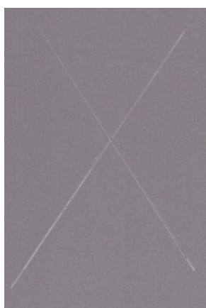
Nátěrové filmy s obsahem MoS_2 -PPy/ Zn_{iso} OKP = 1 % před expozicí, po expozici a po odstranění nátěru
