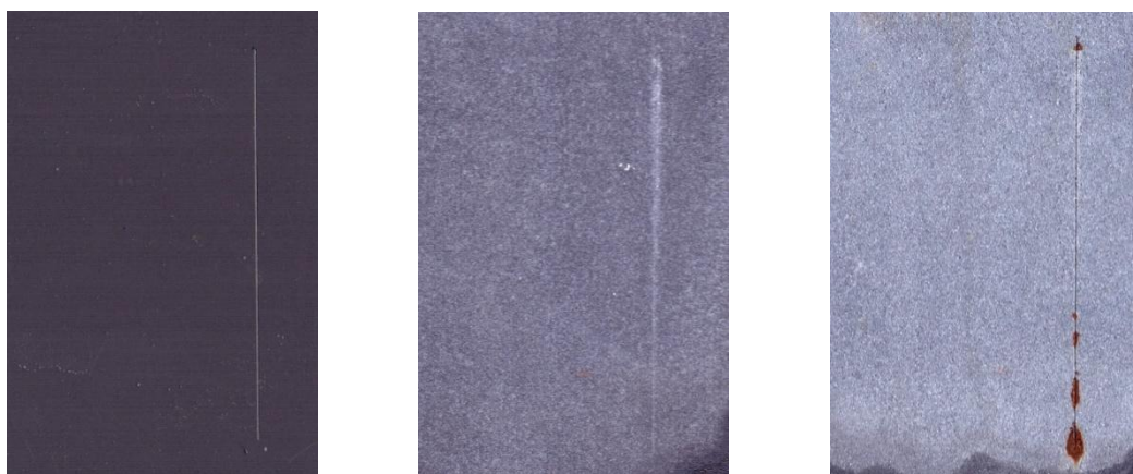
Nátěrové filmy s obsahem Mg/Zn lam OKP = 15 % před expozicí, po 240 hod a 720 hod expozice
