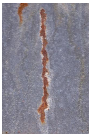
Nátěrové filmy s obsahem Mg / Zn (iso) OKP = 3 % před expozicí, po expozici a po odstranění nátěru
