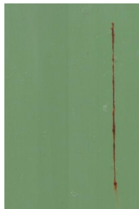
Nátěrové filmy s obsahem Mg OKP = 1 % před expozicí, po 960 hod expozice v atmosféře se solnou mlhou a se střídáním teplot
