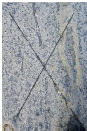
Nátěrové filmy s obsahem Zn_{iso} OKP = 50 % před expozicí, po expozici a po odstranění nátěru
