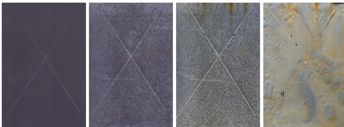
Nátěrové filmy s obsahem Mg/Zn_{lam} OKP = 5 % před expozicí po 1., 2. a 3. cyklu
