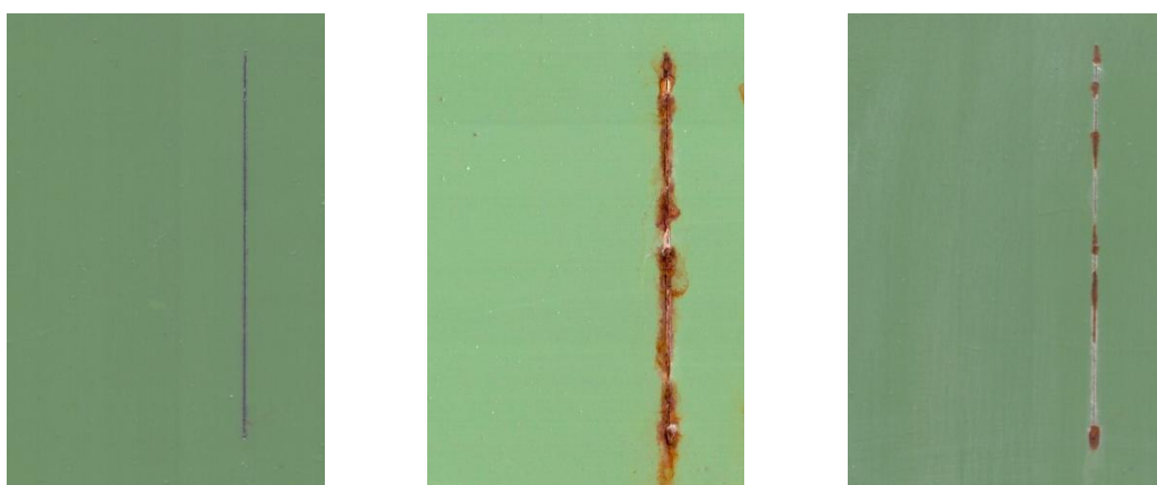
Nátěrové filmy s obsahem Mg/Zn iso OKP = 1 % před expozicí, po 960 hod expozice v atmosféře se solnou mlhou a se střídáním teplot
