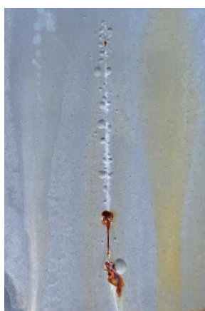
Nátěrové filmy s obsahem WS_2 -PANI/ Zn_{iso} OKP = 5 % před expozicí, po expozici a po odstranění nátěru
