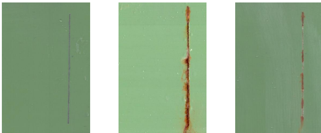
Nátěrové filmy s obsahem Zniso OKP = 50 % před expozicí, po 960 hod expozice v atmosféře se solnou mlhou a se střídáním teplot
