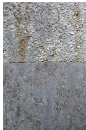
Nátěrové filmy s obsahem Mg/Zn_{lam} OKP = 1 % před expozicí, po expozici a po odstranění nátěru
