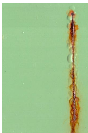
Nátěrové filmy s obsahem Mg OKP = 10 % před expozicí, po 960 hod expozice v atmosféře se solnou mlhou a se střídáním teplot
