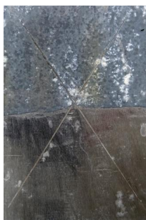
Nátěrové filmy s obsahem Mg/Zn_{iso} OKP = 1 % před expozicí, po expozici a po odstranění nátěru
