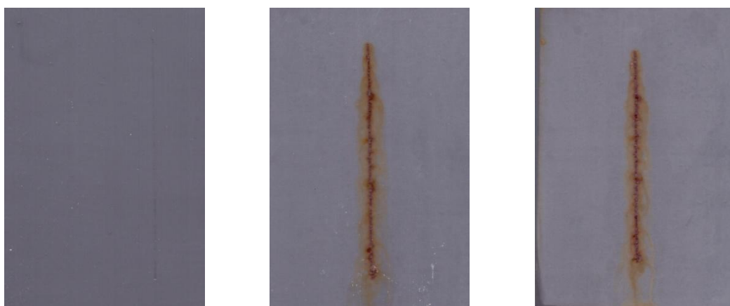
Nátěrové filmy s obsahem WS2-PPy/Zniso OKP = 5 % před expozicí, po 960 a 1680 hodinách expozice
