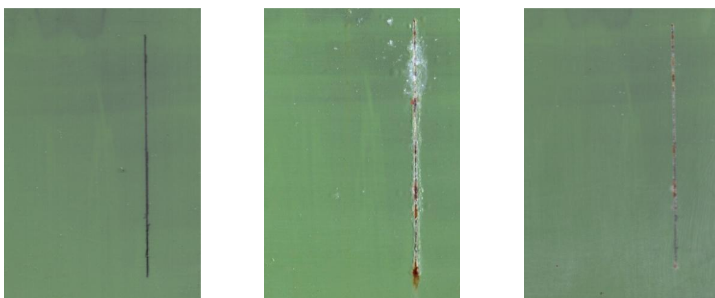
Nátěrové filmy s obsahem Mg/Zn lam OKP = 5 % před expozicí, po 960 hod expozice v atmosféře se solnou mlhou a se střídáním teplot
