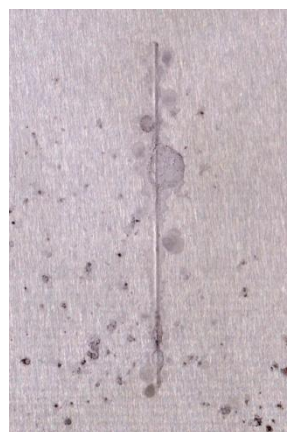
Nátěrové filmy s obsahem Mg OKP = 15 % před expozicí, po expozici a po odstranění nátěru
