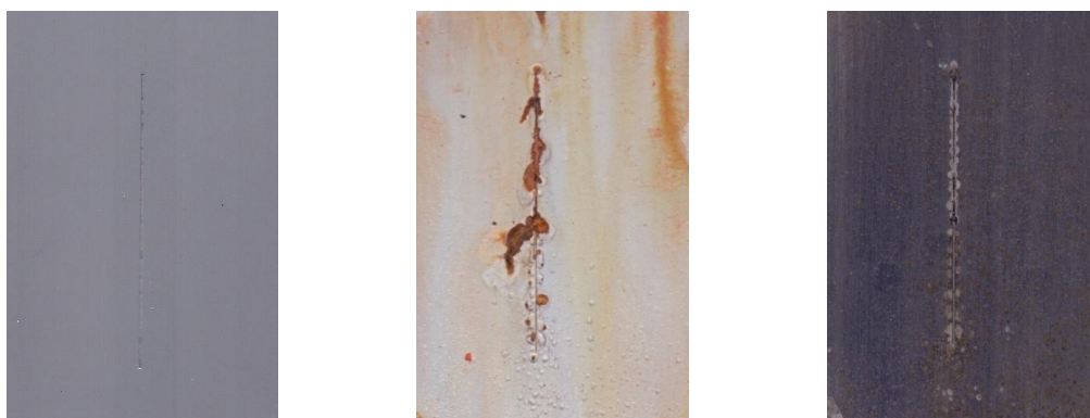
Obrázek 29 Snímky nátěrového filmu s obsahem Zn_{iso} při OKP_{Zn} = 61 % před expozicí, po expozici a po odstranění nátěrového filmu
