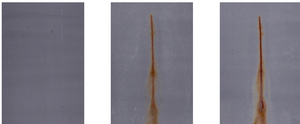
Nátěrové filmy s obsahem \text{WS}_2\text{-PANI/Zn}_{\text{iso}} OKP = 3 % před expozicí, po 960 a 1680 hodinách expozice
