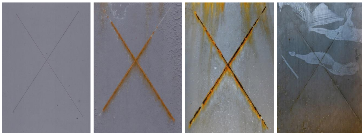
Nátěrové filmy s obsahem \text{MoS}_2\text{-PANI/Zn}_{\text{iso}} OKP = 3 % před expozicí po 1., 2. a 3. cyklu
