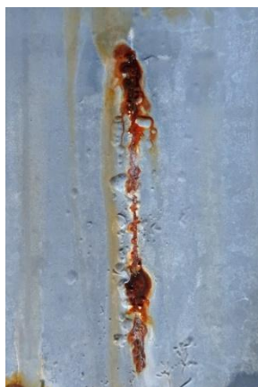
Nátěrové filmy s obsahem WS_2 -PANI/ Zn_{iso} OKP = 3 % před expozicí, po expozici a po odstranění nátěru
