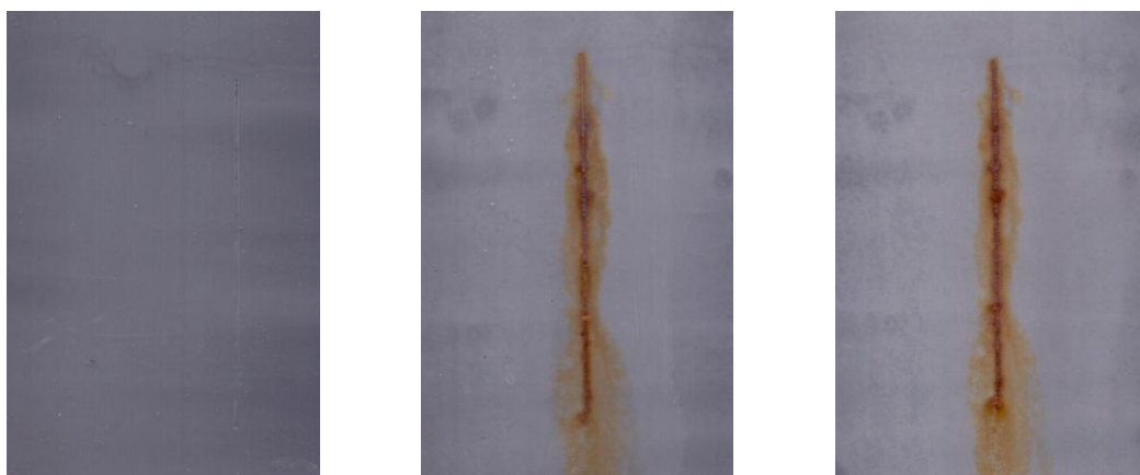
Nátěrové filmy s obsahem \text{MoS}_2\text{-PPy/Zn}_{\text{iso}} OKP = 1 % před expozicí, po 960 a 1680 hodinách expozice
