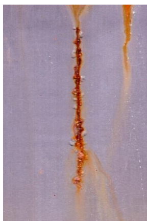
Nátěrové filmy s obsahem Mg / Zn (lam) OKP = 5 % před expozicí, po expozici a po odstranění nátěru
