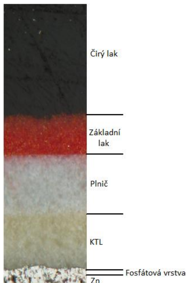
Obrázek 9: Zobrazení vrstev laku nátěrového systému pro lakování karoserií v řezu [37]
