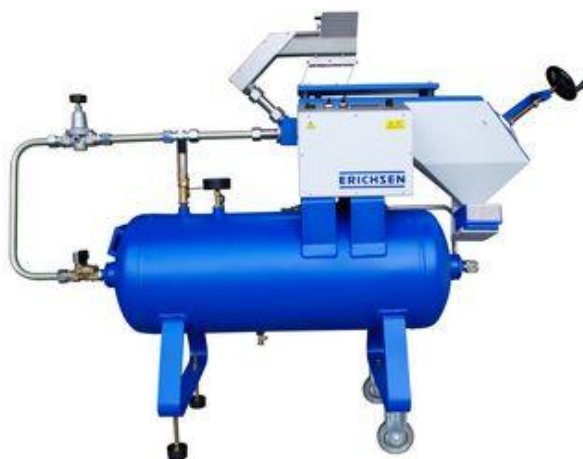
Obrázek 25: Zařízení pro měření otrysku kamínků [58]
