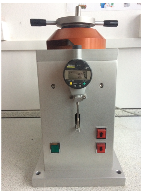
Obrázek 23 Erichsonův přístroj pro deformaci hloubením
