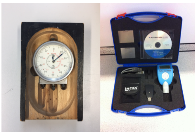
Obrázek 20 vlevo: tříbodový tloušťkoměr; vpravo: elektromagnetický hloubkoměr MINITEST 1100
