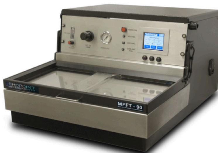
Obrázek 17 Přístroj MFFT 60 pro stanovení minimální filmotvorné teploty, převzato z [94]
