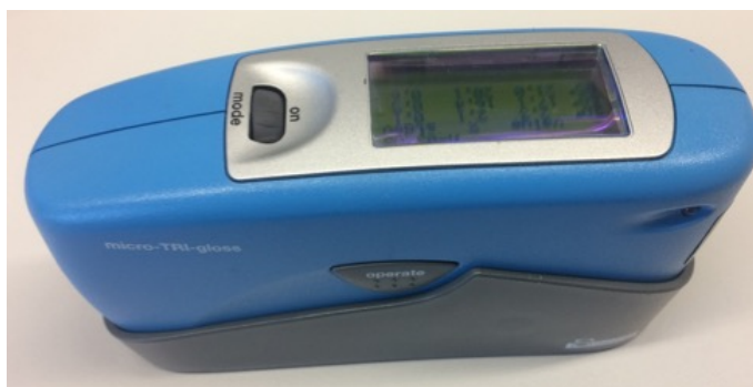
Obrázek 19 Leskoměr Micro Tri – Gloss
