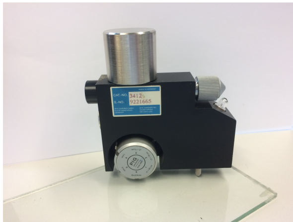
Obrázek 22 Buchholzův přístroj pro stanovení tvrdosti nátěrů
