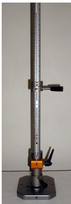
Obrázek 24 Přístroj Elcometr pro deformaci úderem
