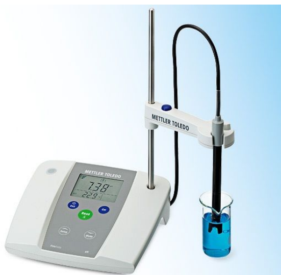
Obrázek 15 pH metr Mettler Toledo FE20 FiveEasy; převzato z [92]
