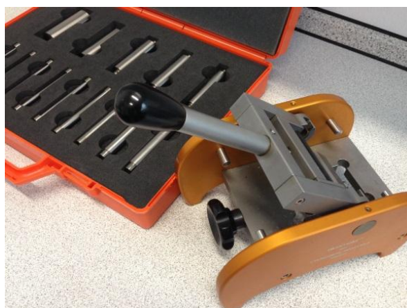
Obrázek 25 Přístroj Elcometer pro deformaci ohybem
