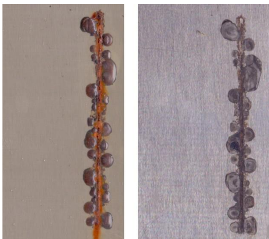
CaCO 3 , s nátěrem, bez nátěru
