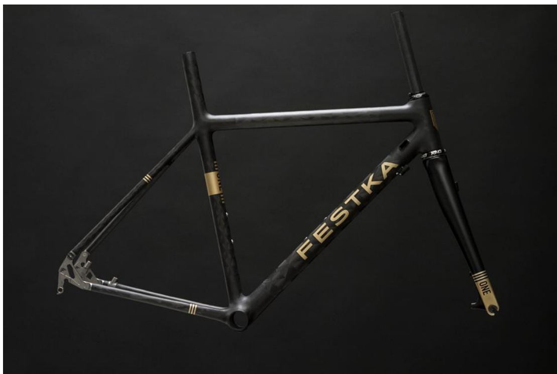
Obrázek 1: Rám kola FESTKA One disc vyrobený z kompozitních trubek z uhlíkových vláken pojených k sobě ruční laminací (2)
