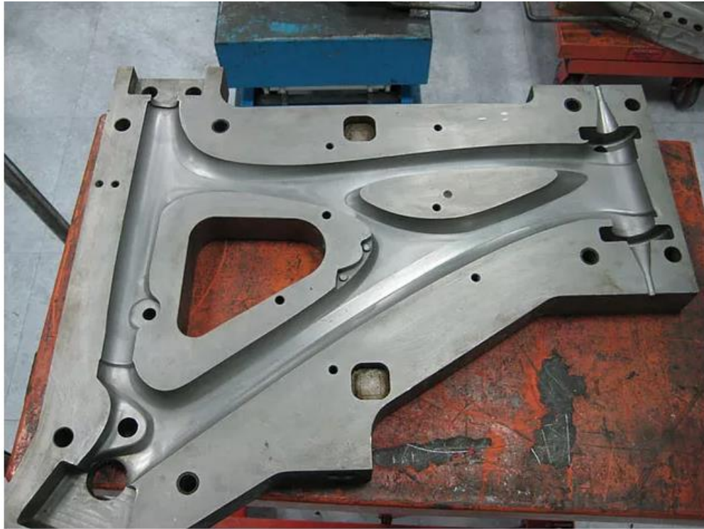
Obrázek 20: Forma pro výrobu monocoque rámu z prepregu pomocí autoklávu (29)
