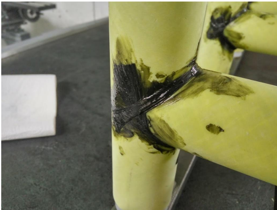
Obrázek 26: Svazek uhlíkových vláken nanesený do hrany lepeného spoje
