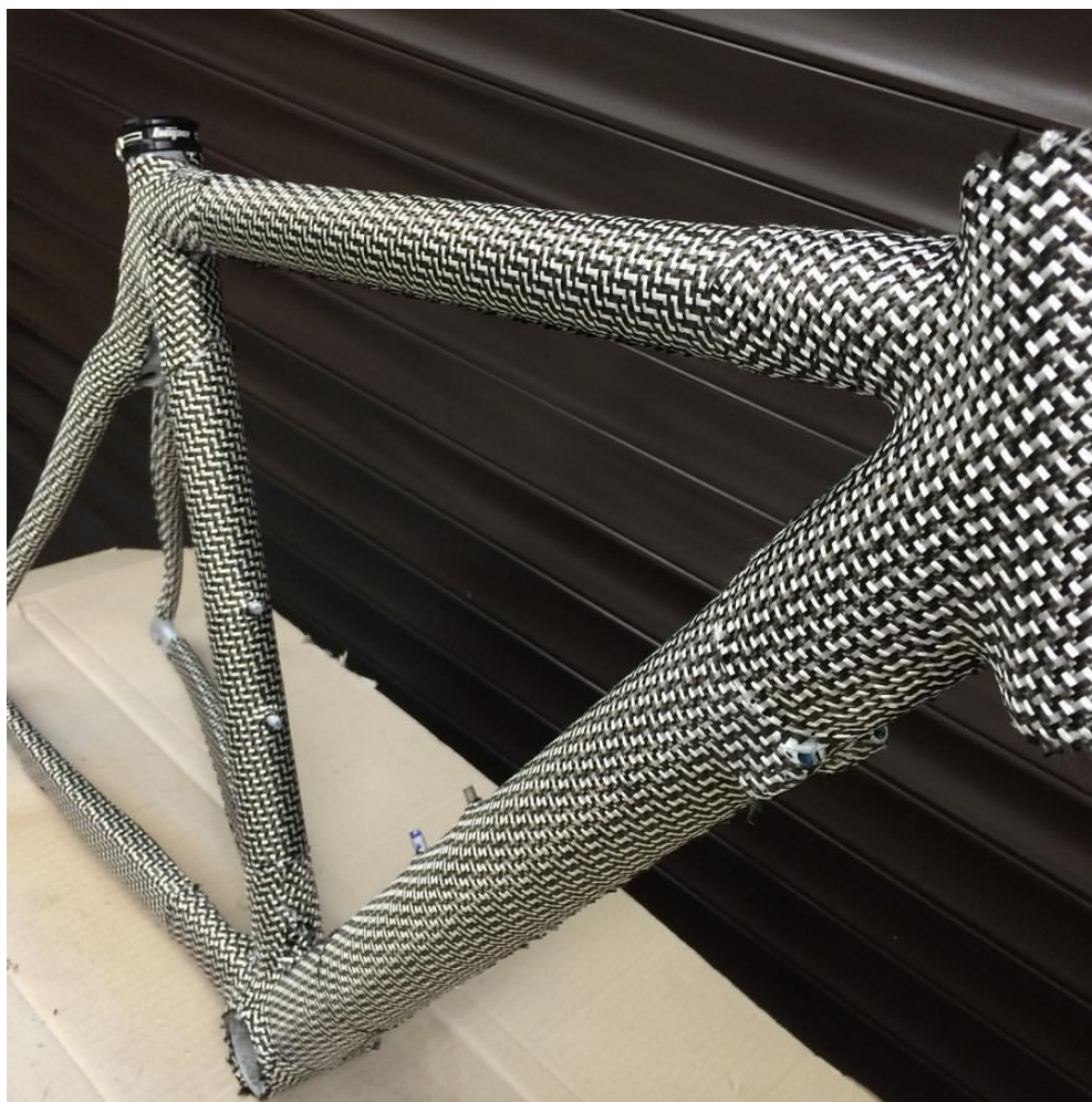
Obrázek 7: Prototyp rámu kola od výrobce Filament bikes využívající hybridní tkaninu z uhlíkových a UHMWPE vláken Dyneema (17)
