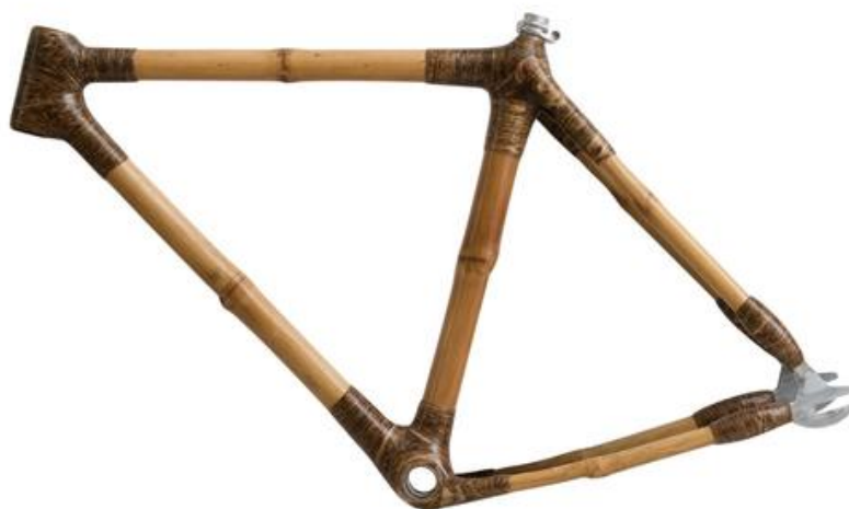
Obrázek 5: Rám jízdního kola od výrobce BooBoo Bikes konstrukčního typu tube-to-tube, kde je jakožto trubkový materiál využit bambus a jako vláknenná výztuž pro laminaci spojů je využito konopné vlákno (10)
