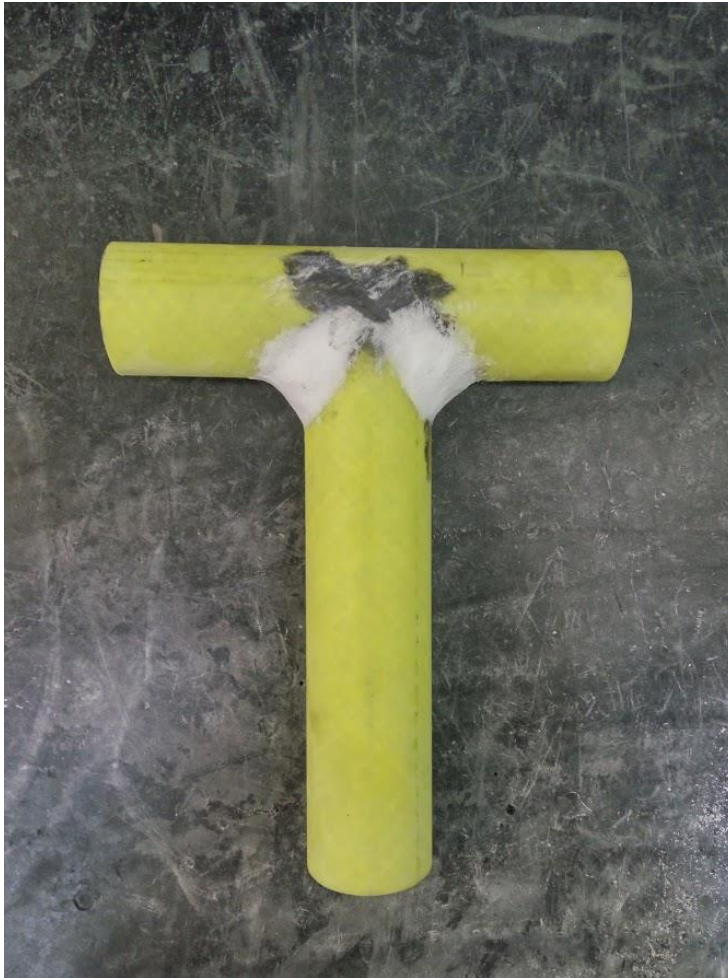
Obrázek 28: Zkušební těleso s nanesenou "bílou hmotou" jakožto podklad a tvarovou definicí laminovaného spoje
