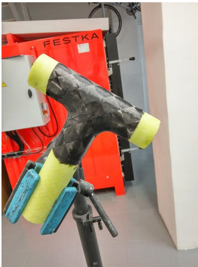
Obrázek 33: Vrstva tkaniny TeXTreme 1027 použitá jako v pořadí třetí vrstva v laminaci spoje typu FESTKA Scalatore
