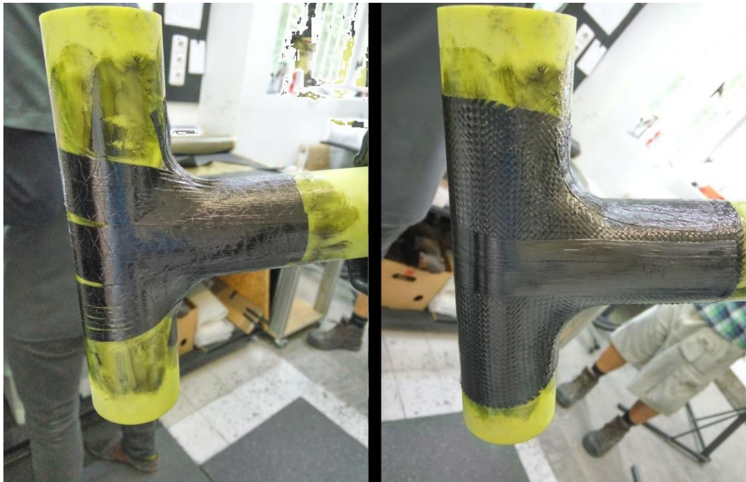
Obrázek 31: Nanesená první vrstva UD pásků Aspro AT40 (vlevo) a nanesené plátno Style 461 jako druhá laminační vrstva a započaté nanášení třetí vrstvy v podobě dalších UD pásků AT40
