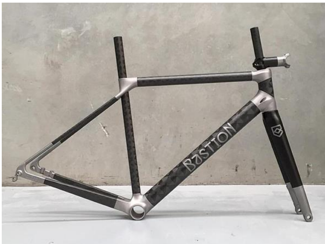
Obrázek 2: Rám kola Bastion Road disc vyrobený z kompozitních trubek z uhlíkových vláken pojených k sobě pomocí rámových spojek z titanu vyrobených technologií 3D tisku (3)
