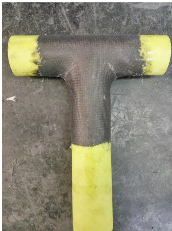
Obrázek 30: Hotové zkušební těleso připravené pro provedení pevnostních zkoušek
