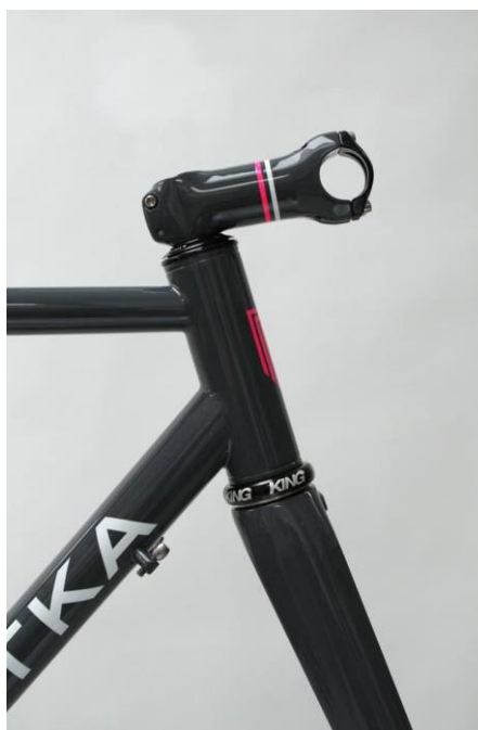
Obrázek 23: Spoj hlavové (head tube) a horní (top tube), resp. dolní (down tube) rámové trubky který simulují zkušební tělesa (32)
