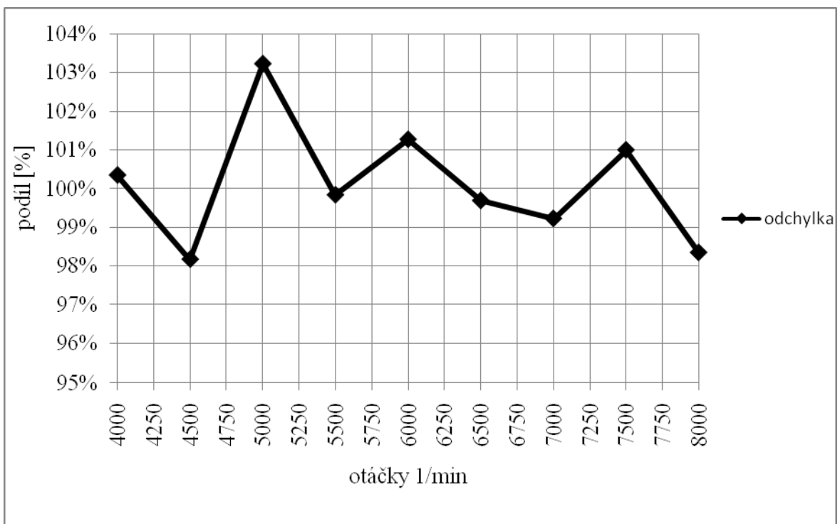
Obrázek 4-28 Statické měření výkonu motoru Amit vs Freescale
