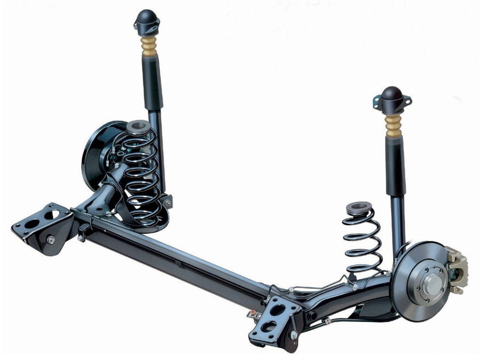
Obrázek 3 náprava s torzním propojovacím prvkem VW polo[3]
