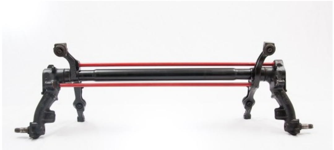
Obrázek 2 Kliková náprava s odpružením torzní tyčí Citroenu Saxo [4]
