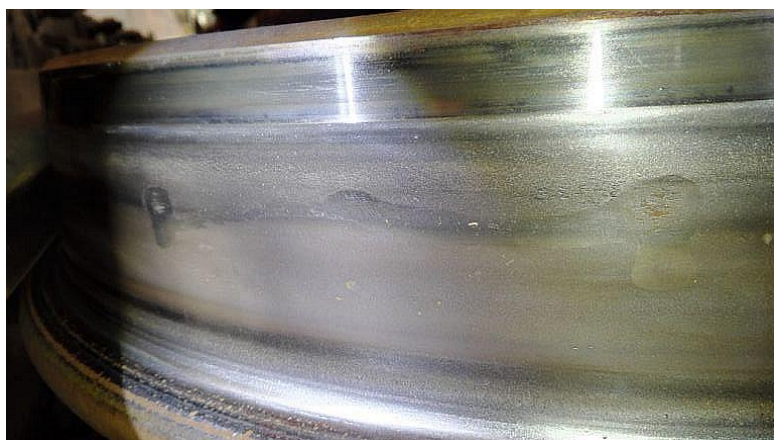
Obr. 4 Nalezená porucha jízdni plochy kola u soupravy č. 108, nápravy č. 7
